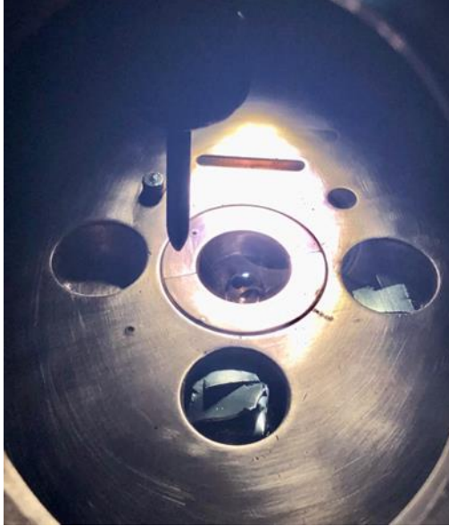
Figura 11: Cámara de horno de arco eléctrico se observan las cargas antes de fundirse (Mo- Zr, Al-Cr-Ti).
