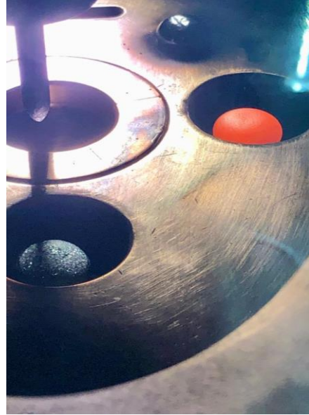
Figura 12: Cámara de horno de arco eléctrico se observan las aleaciones maestras fundidas (Mo-Zr, Al-Cr-Ti).
