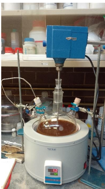
Figura 19. Equipo para tratamiento alcalino a mayor escala.
