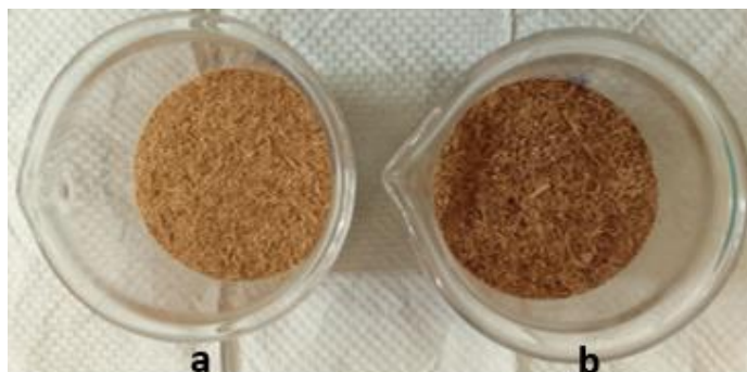
Figura 13. Finos obtenidos del BSG con tamiz malla 20.
