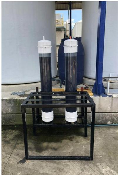
Figura 8. Sistema de prototipos anaerobios.
