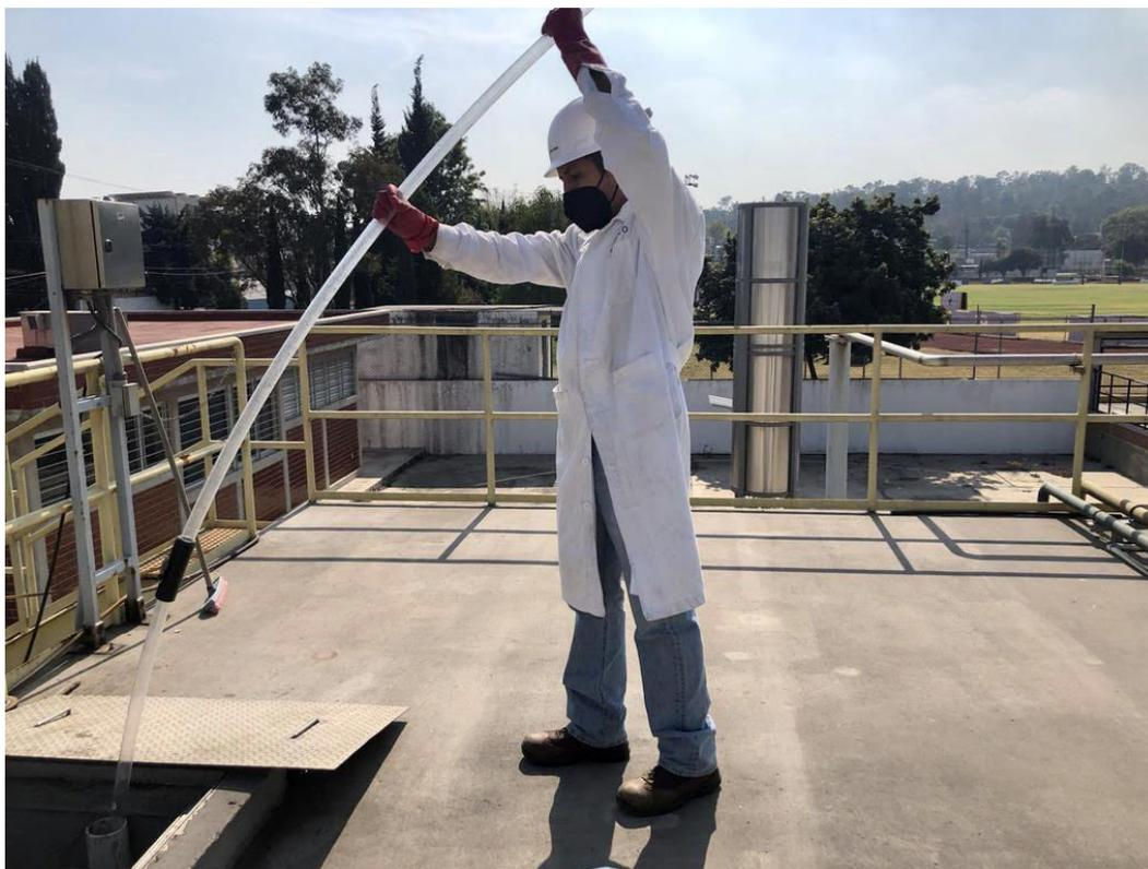
Figura 6.- Toma de muestra de lodo del Reactor Anaerobio.
