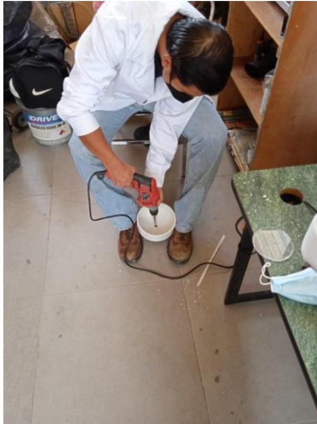
Figura 4.- Perforación de tapa de PVC.
