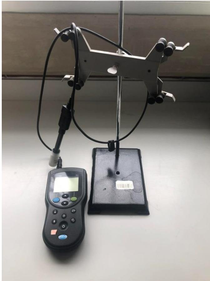
**Figura 7. Potenciómetro HACH-HQ-30D.**
