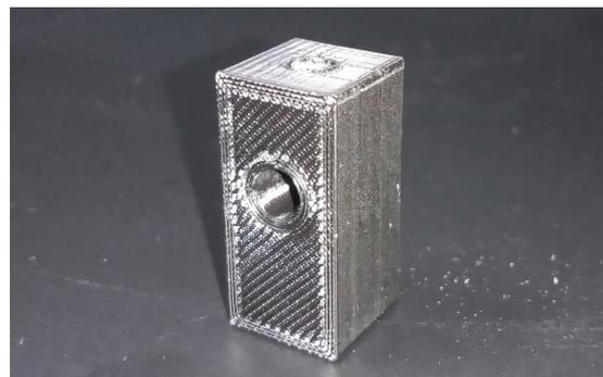
(f) Diseño impreso de los bloques auxiliares que complementan con la montura del DMD
