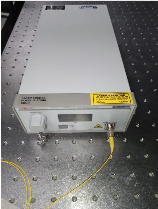
(a) Fuente láser modelo *S1FC660* con una longitud de onda de 660 nm. Se muestra como uno de los extremos de la fibra óptica está conectado al láser.
