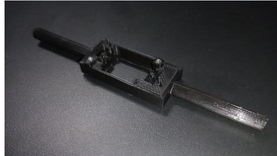
(b) Diseño impreso de la montura para el DMD
