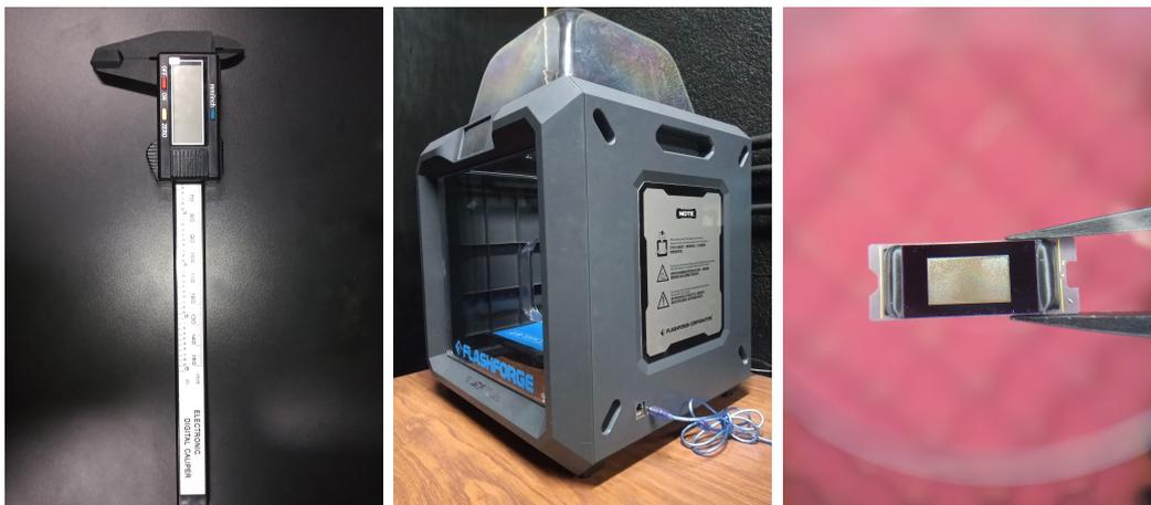
(a) Vernier electrónico digital (b) Impresora 3D FLASHFORGE (c) DMD sostenido por pinzas de plástico
