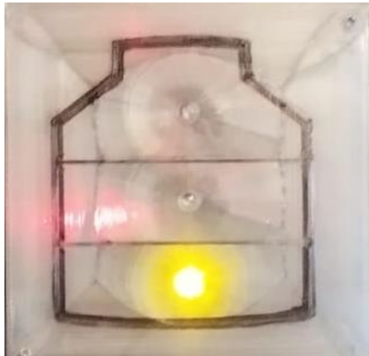
Ilustración 4.27 visualización del nivel de agua en el tinaco 1% al 33%.
