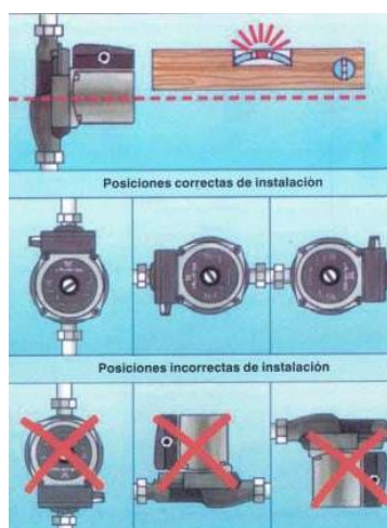
Ilustración 2.11 posiciones de instalación.
