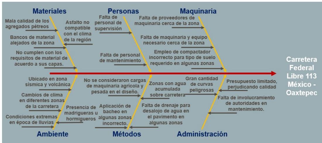
Ilustración 32. Análisis mediante diagrama de Ishikawa para fallas presentadas en el pavimento de la Carretera Federal Libre 113, México - Oaxtepec. Fuente: Propia.
