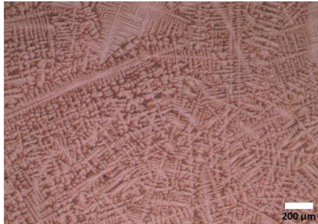
Figura 2.19. Microestructura en condición de solidificación para el acero Fe-27Mn-7Al-1.2C-0.019Ti-0.0053B.
