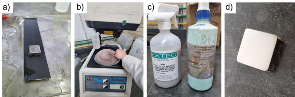
Figura 3.10. Etapas de la preparación metalográfica de las probetas: a) Desbaste, b) Pulido fino, c) Suspensión de diamante empleadas y d) Superficie final de la pieza secada con aire caliente.
