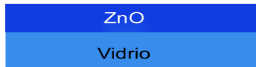
Figura 13. Representación esquemática del depósito de ZnO sobre vidrio.
