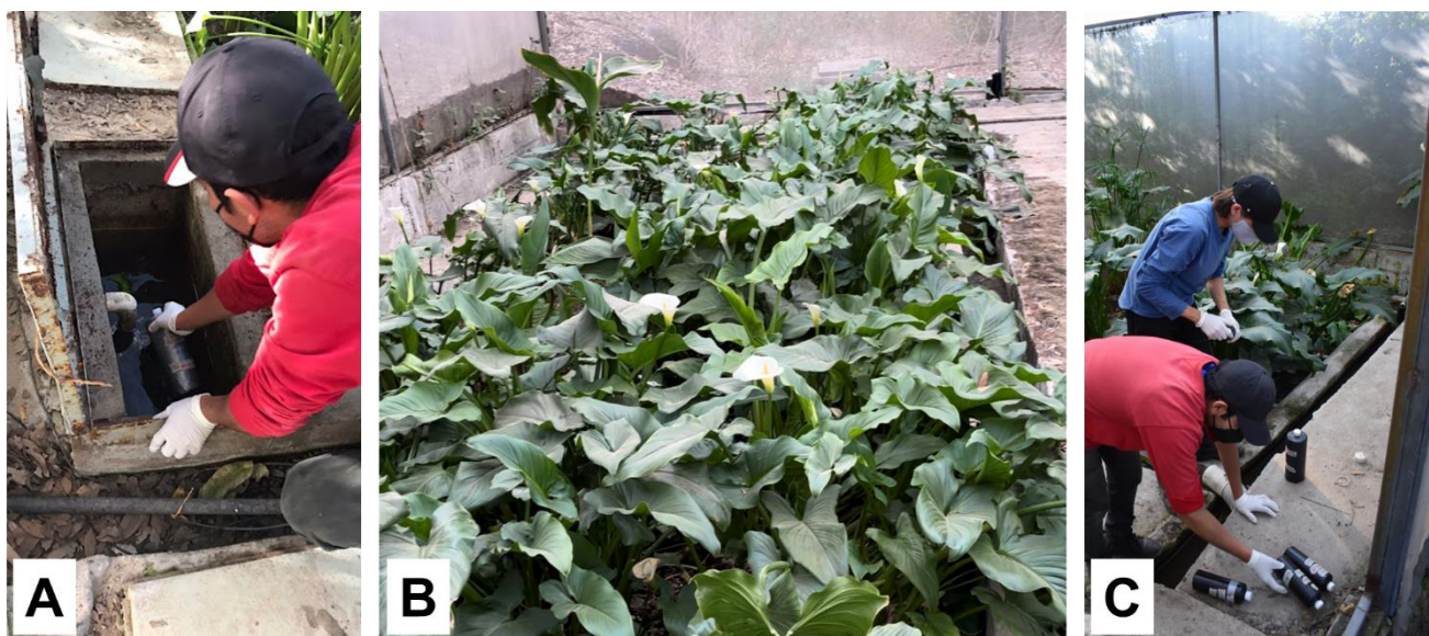
Figura 2. Toma de muestras en la planta de tratamiento de la A.C. Mateo Quinto en de la salida de la canaleta 2 (A) conformada por un humedal de flujo subsuperficial (B) y en el compartimento de mezcla de aguas jabonosas y negras (C).
