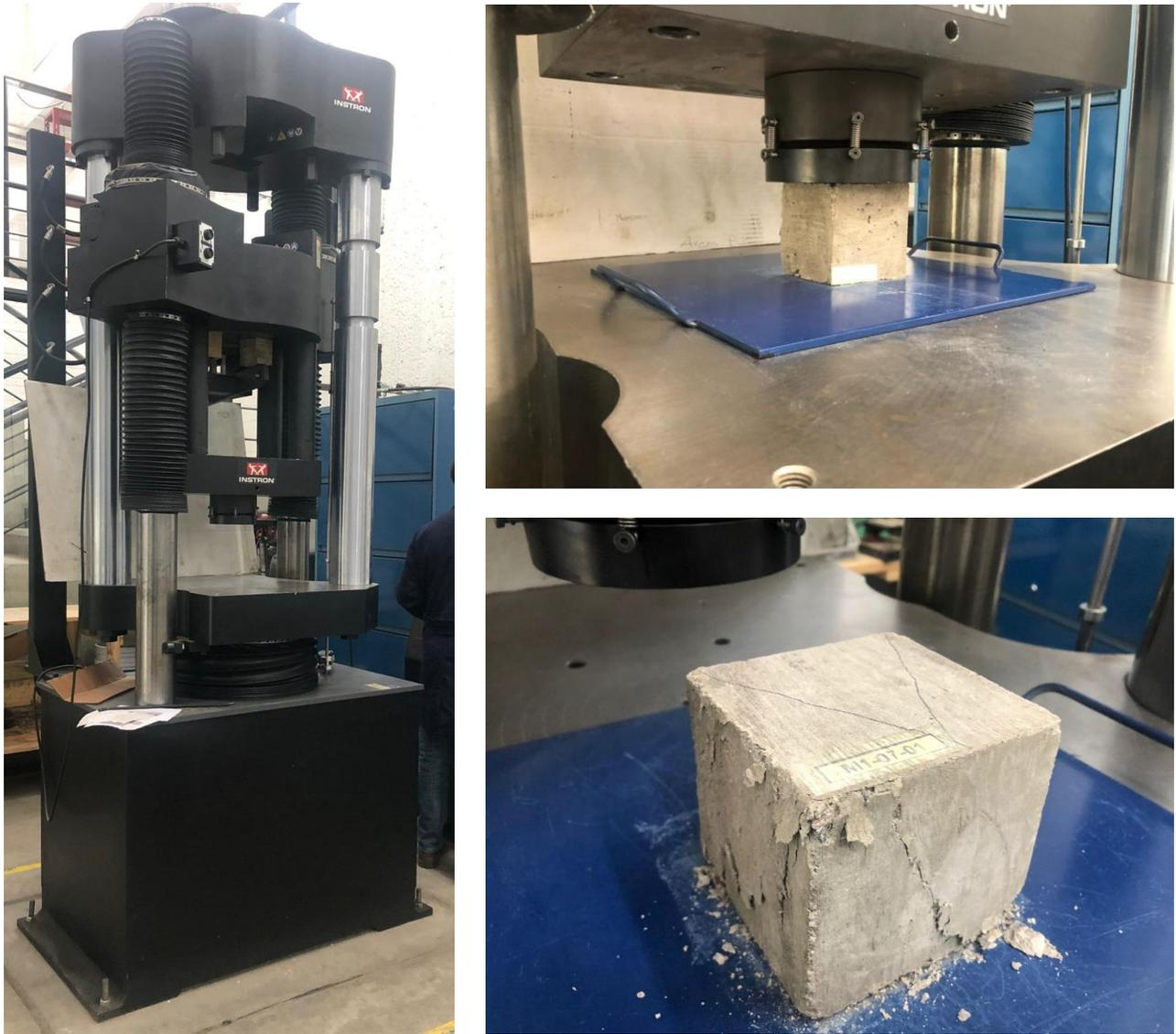
Notas: Máquina de pruebas universales, del Laboratorio de Materiales y Sistemas Estructurales de la Facultad de Arquitectura UNAM. Muestras de concreto ensayadas.
