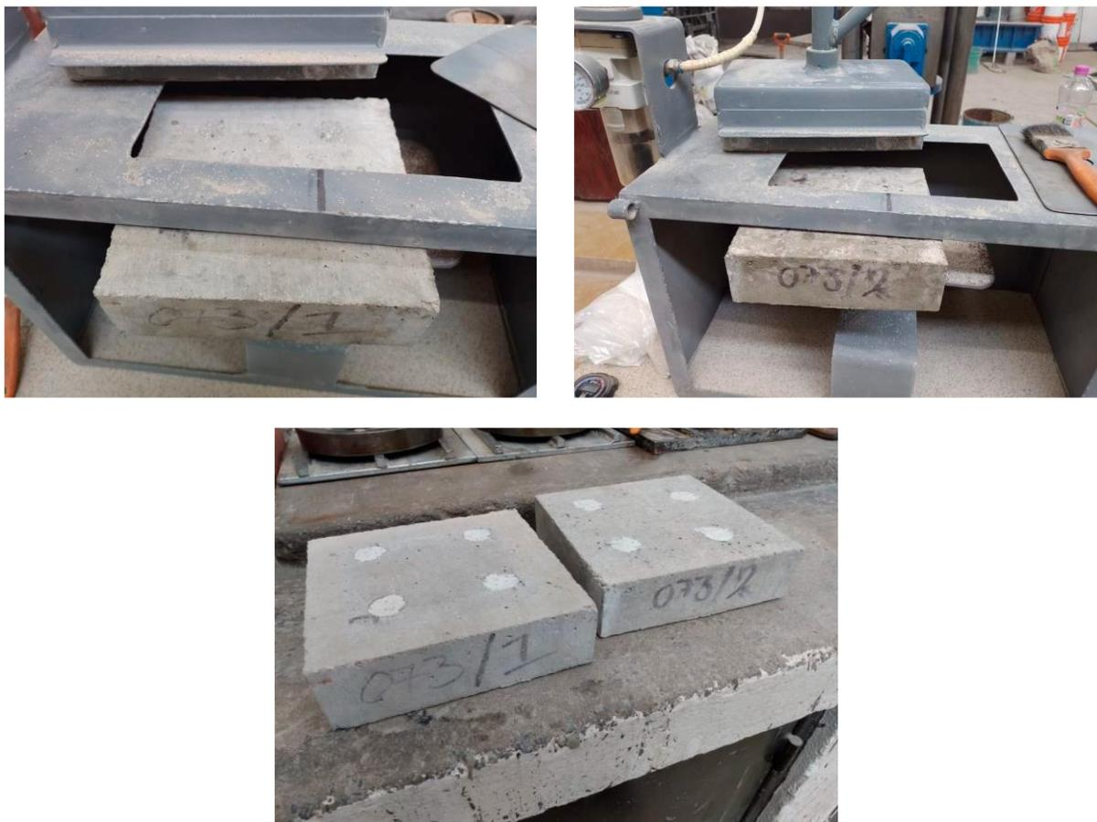
Notas: Fotografías 1 y 2.- Muestras 073/01 y 02 sometidos al ensayo de Abrasión. Fotografía 3.- Muestras 073/01 y 02 después del ensayo de Abrasión y de aplicar la plastilina para determinar el coeficiente de pérdida volumétrica por abrasión.
