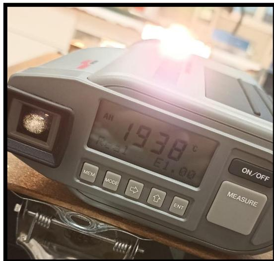
*Figura 52 Lectura de pirómetro óptico.*
