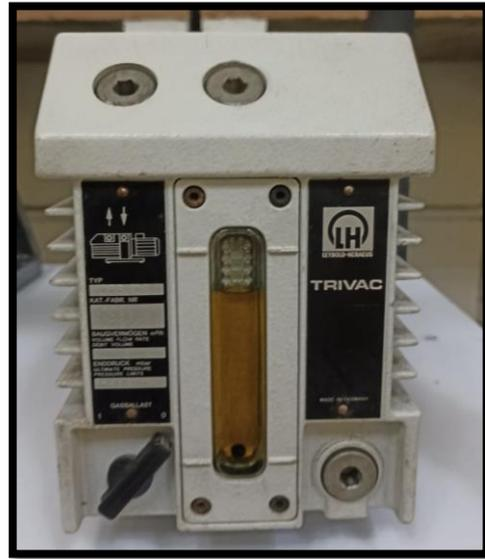
Figura 15 Bomba de vacío vista.
