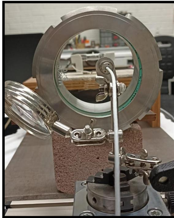
*Figura 53 Sensor infrarrojo con mirilla de borosilicato*
