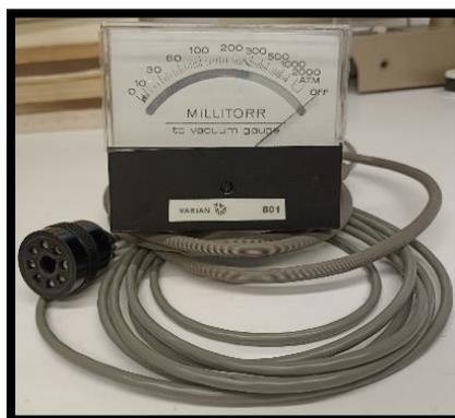
Figura 20 Vacuómetro con unidades en mili torr con conector para sensor de vacío.
