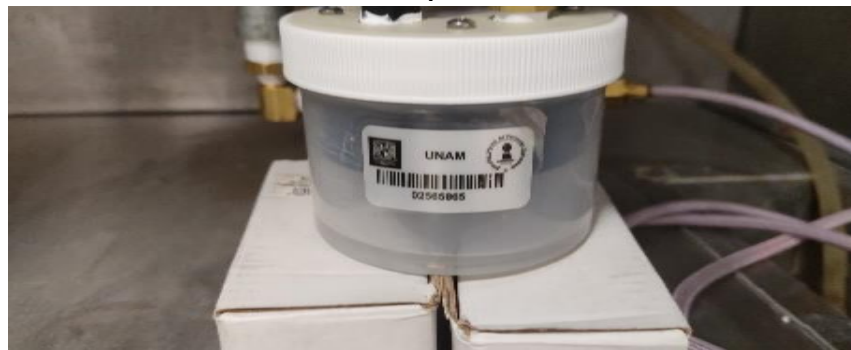
Figura 6. Nebulizador TSI llenado con la solución de PBS.
