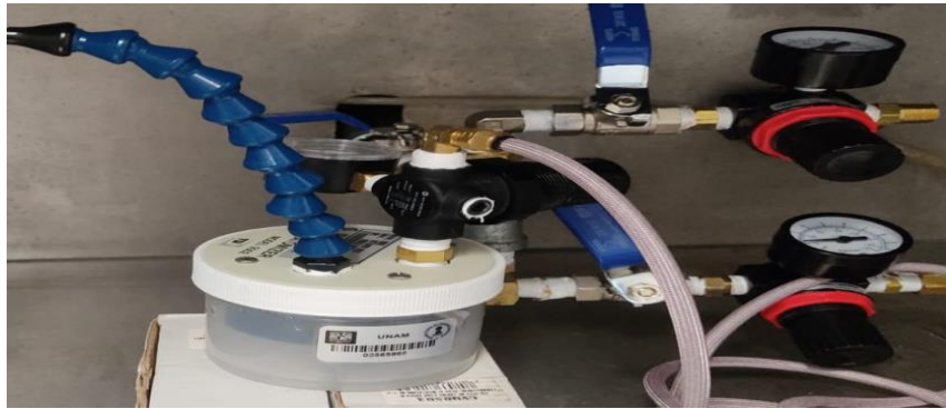
Figura 5. Montaje del nebulizador TSI a la toma de aire.
