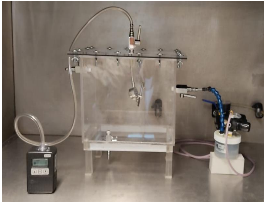
Figura 10. Montaje de la metodología empleada para la captura de aerosoles dentro de la cámara de contacto.
