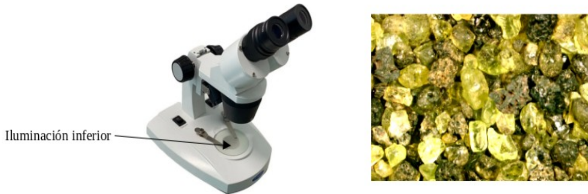
Fig. 9 Microscopio utilizado para la separación de los minerales. La imagen derecha ejemplifica la apariencia de los piroxenos cuando incidía a través de ellos la iluminación inferior del microscopio.
