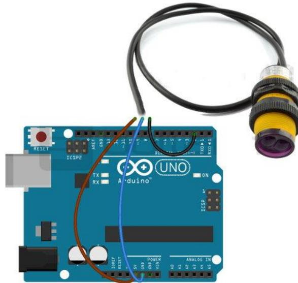
*Figura 4.1. Circuito para pruebas con el sensor E18-D80K*
