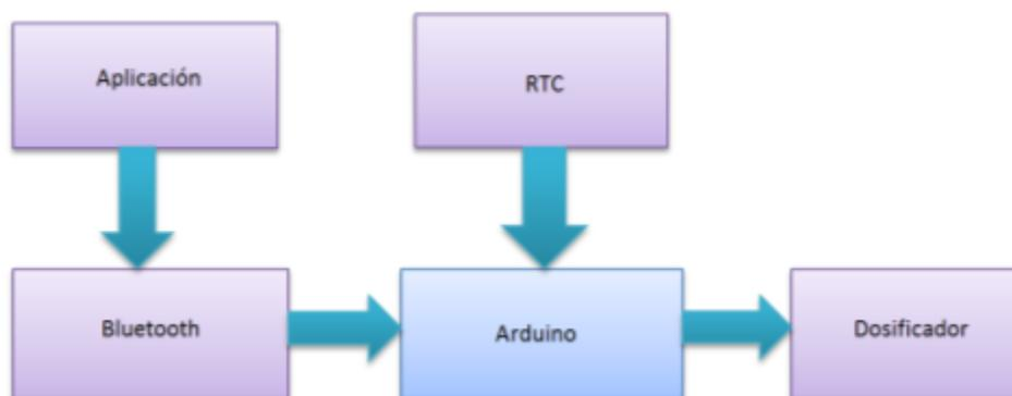
*Figura 1.3. Diagrama a bloques del dispensador desarrollado en el 2019*
