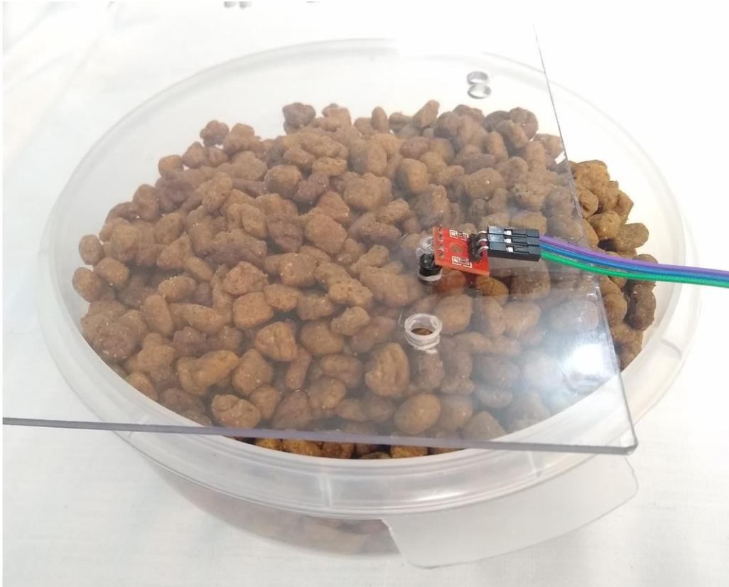
*Figura 4.5. Prueba de detección de alimento con el sensor infrarrojo de cuatro canales*
