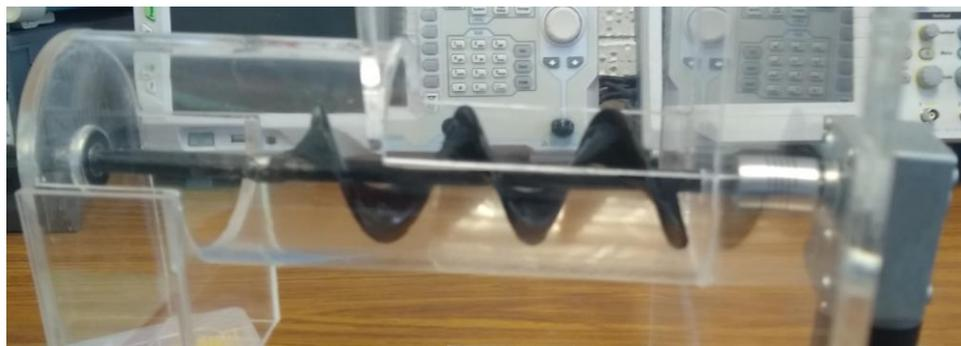
*Figura 3.17. Mecanismo para el accionamiento del tornillo sin fin. Desde la derecha hacia la izquierda: motorreductor, cople y tornillo sin fin.*
