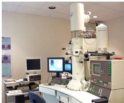
Figura 4.8. Equipo de microscopia de transmisión electrónica de Instituto de Física, Laboratorio Central de Microscopia
