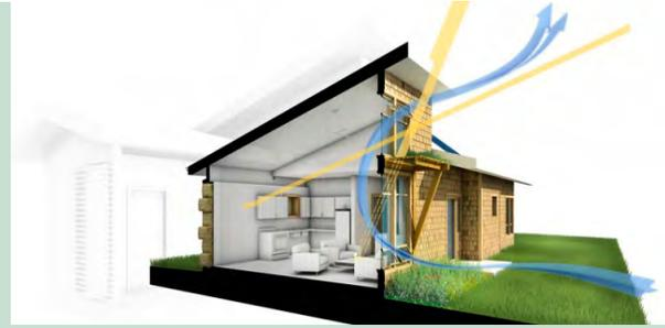
Imagen 83. Implementación de elementos arquitectónicos para lograr un confort térmico al interior.
