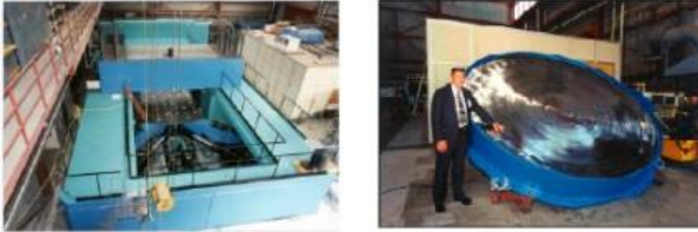
Figura 1.11: Instalaciones de pruebas de dispositivos de modificación de la respuesta sísmica de Caltrans (izquierda) y la superficie cóncava de un péndulo de fricción grande (derecha).
