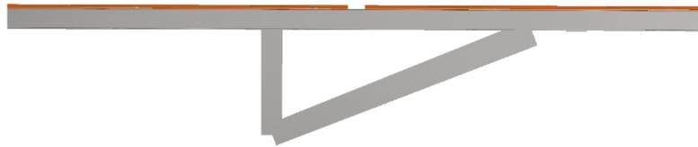
Ilustración 40. Pasillos con perfiles en ángulos anclados al suelo
