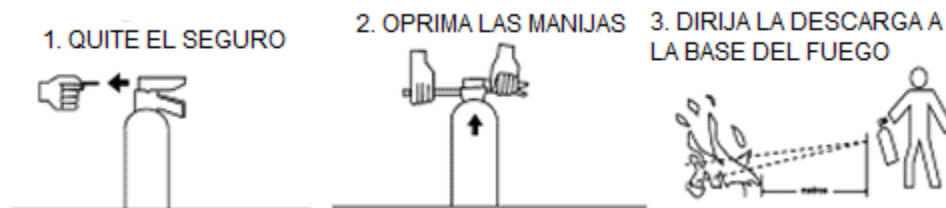
FIGURA 1. IMÁGENES Y LEYENDAS QUE ILUSTRAN LA NEMOTECNIA DE OPERACIÓN DE LOS EXTINTORES PORTÁTILES
