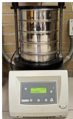
Figura 44. Tamizador para la homogeneización del tamaño de partícula de PPG.
