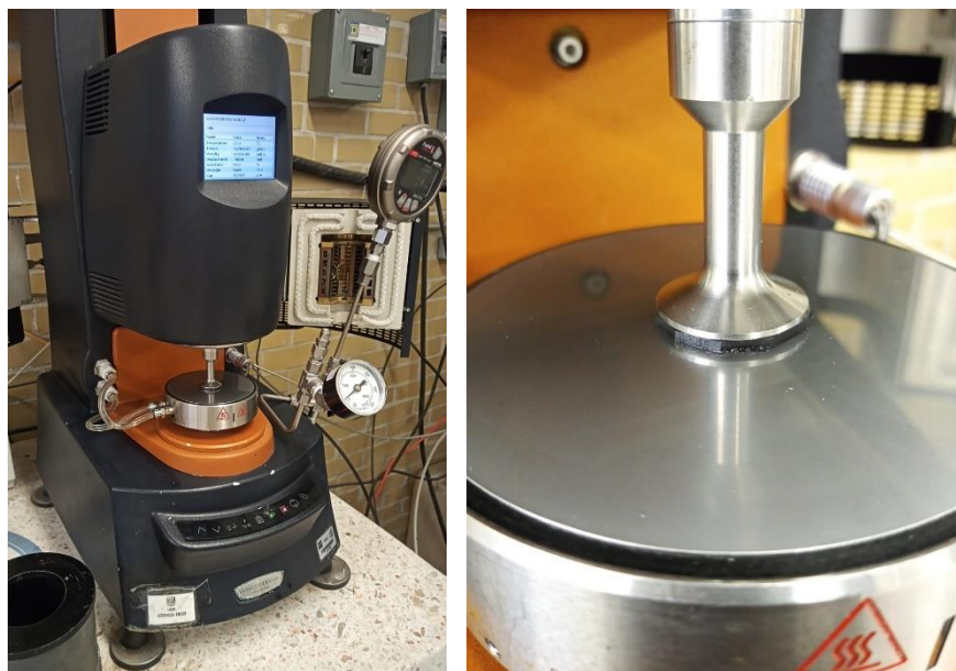
Figura 47. Reómetro DHR-3 donde se realizaron las evaluaciones mecánicas de los PPG.
