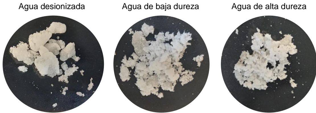
Figura 55. Imágenes de PPG-0.5A hinchados en los diferentes medios y después de 3 horas de filtración.
