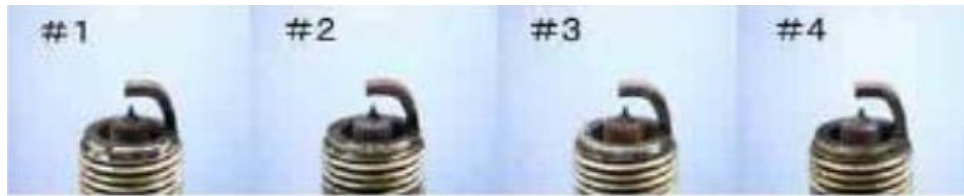
Figura 27. Fotografía de la bujía realmente usada en el área donde se usa ferroceno.
