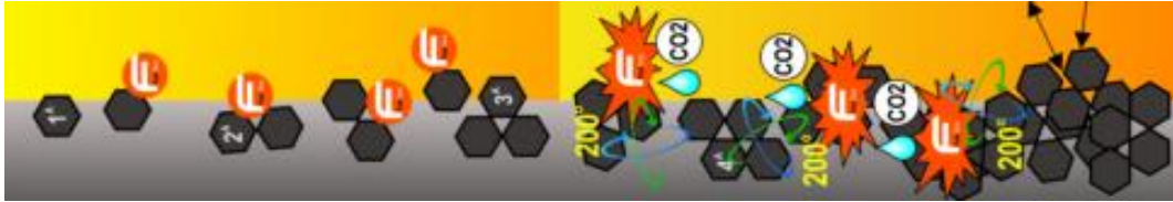
Figura 51 Funcionamiento de las pastillas Ferrox como catalizador en combustibles.
