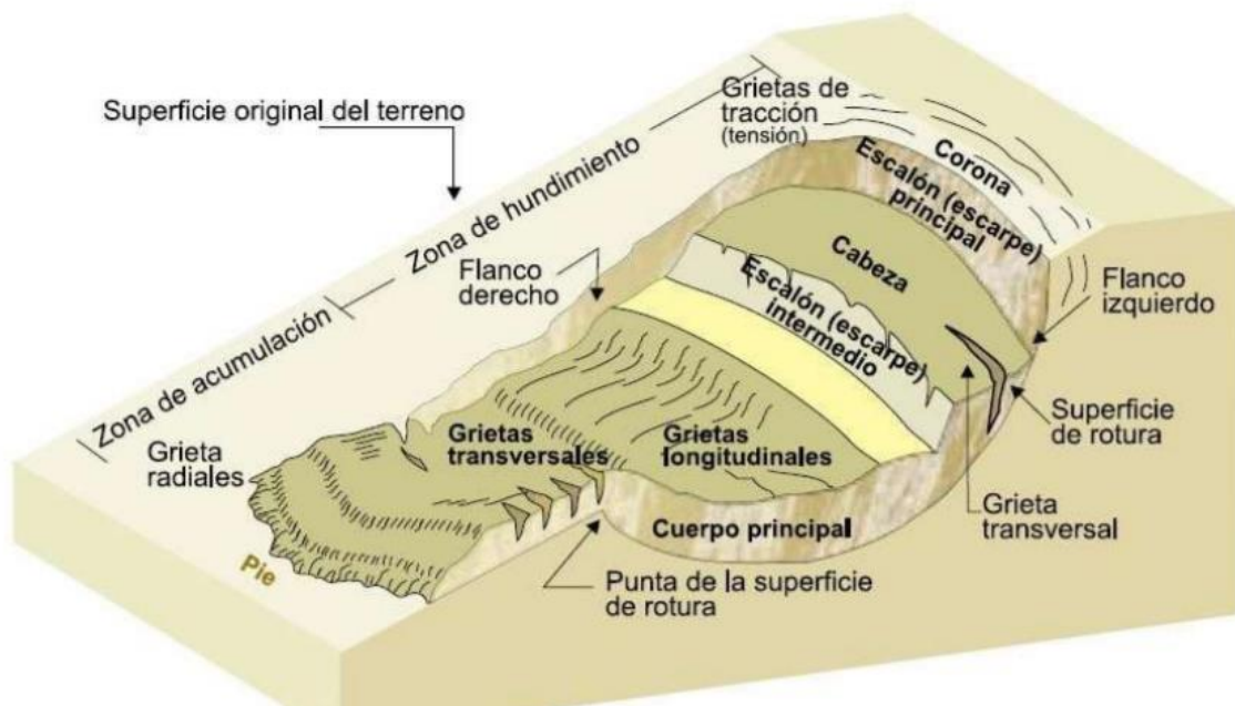
Figura 3.11 Partes que componen un deslizamiento rotacional. (CENAPRED, 2016)
