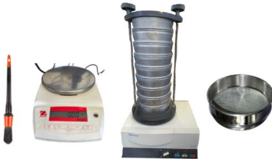
Figura 2.2.1. 1. Instrumentos utilizados para la prueba granulométrica por tamices
