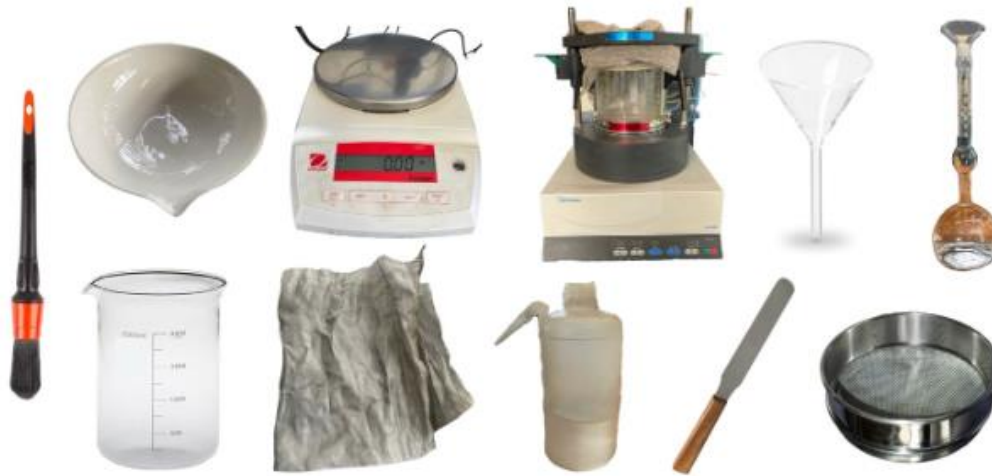
Figura 2.2.1. 4. Instrumentos utilizados para la obtención de la densidad relativa por picnómetro
