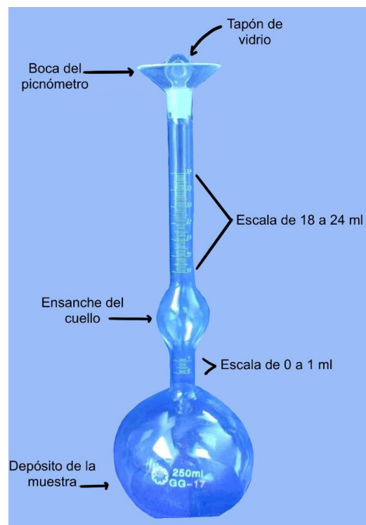
Figura 2.2.1. 3. Picnómetro utilizado en el Laboratorio de Sedimentos del GICP
