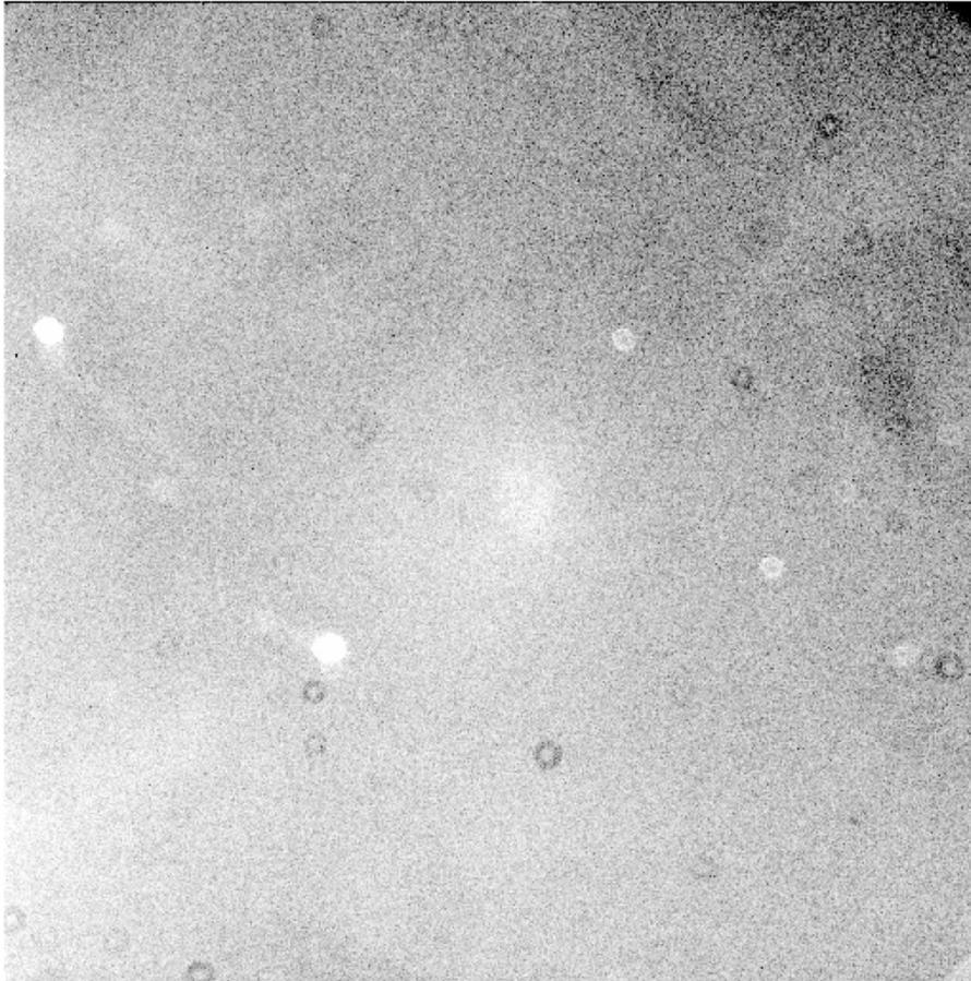
Figura 1.7: Muestra de un *Flat frame* correspondiente a la noche del 11 de diciembre de 2019. Este Flat, corresponde al filtro I, en una escala de  $1024 \times 1032$  pixeles. Las numerosas "donas" son motas de polvo desenfocadas presentes en el lente y el filtro. El nivel de brillo variable y las estructuras son comunes en las imágenes de campo plano.
