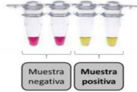
Figura 3. Detección de amplificación mediante cambio de color en la mezcla de reacción. El kit WarmStart® Colorimetric LAMP 2X Master Mix (DNA & RNA) de NEB, contiene un indicador de pH en la mezcla de reacción que cambia de color cuando la polimerasa de ADN Bst 2.0 amplifica el gen de interés.
