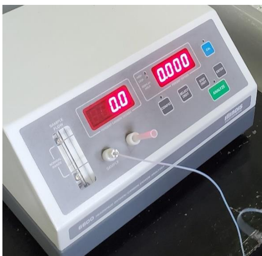
Figura 9. Medidor de oxígeno Illinois Instruments modelo 6600. Fuente: Elaboración propia, 2023.
