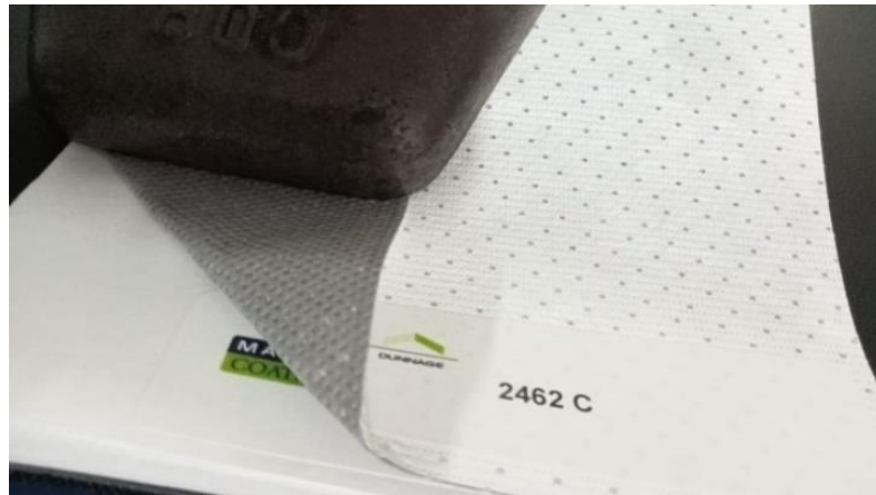
Figura 5. Material Tyvek para la elaboración de los sobres. Fuente: Elaboración propia, 2023.
