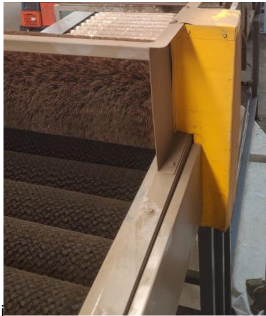
Figura 20. Cepillado de aguacate por banda transportadora. Fuente: Elaboración propia, 2023.
