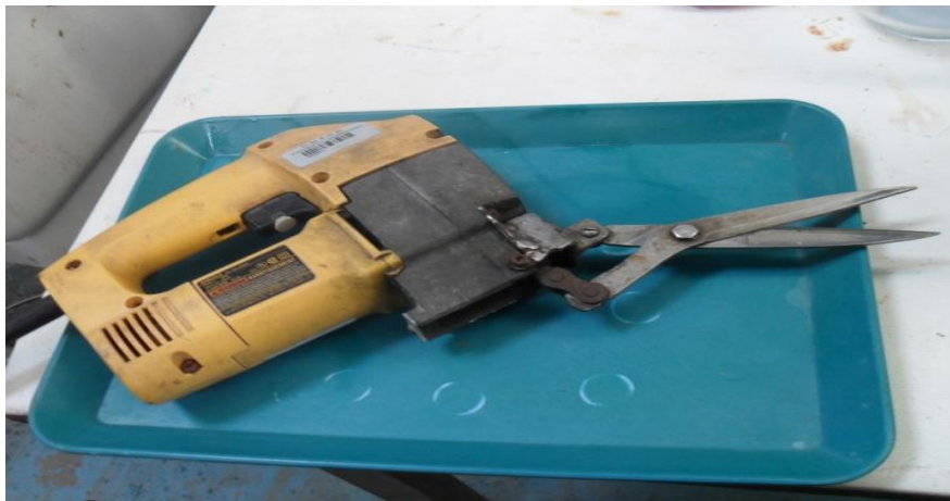
Figura 4. Prototipo de tijeras mecánicas utilizadas en el laboratorio
