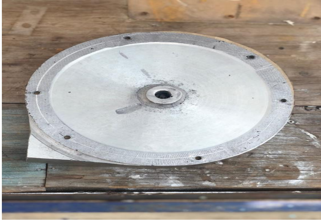
Figura 4.10. Foto de la carcasa de la máquina del ciclo Rankine de la Fes Aragón
