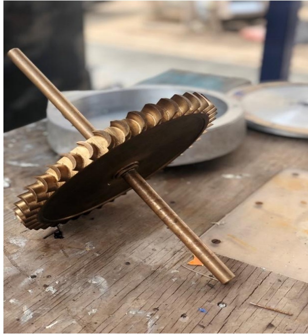
Figura. 4.13. Foto de eje y álabes de la turbina del ciclo Rankine de la Fes Aragón
