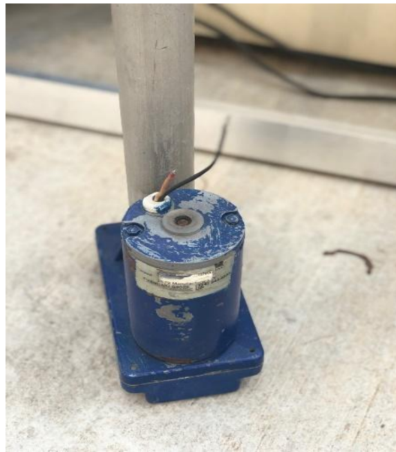
Figura 4.16 foto motor eléctrico del pistón para el sistema móvil del equipo de parábolas.
