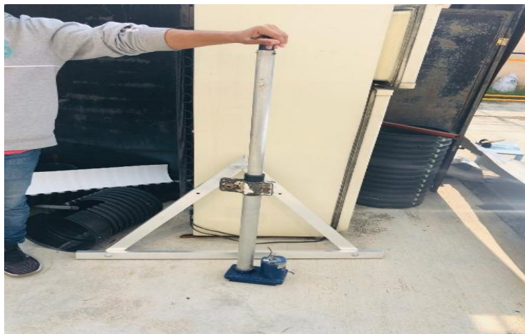
Figura. 4.18. Foto del pistón o brazo para el sistema móvil de las parábolas.
