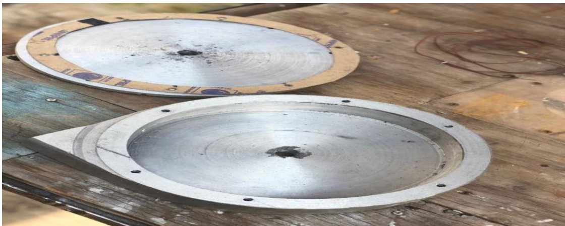
Figura. 4.12. Foto de las dos partes de la carcasa y tapa elaborada en aluminio.
