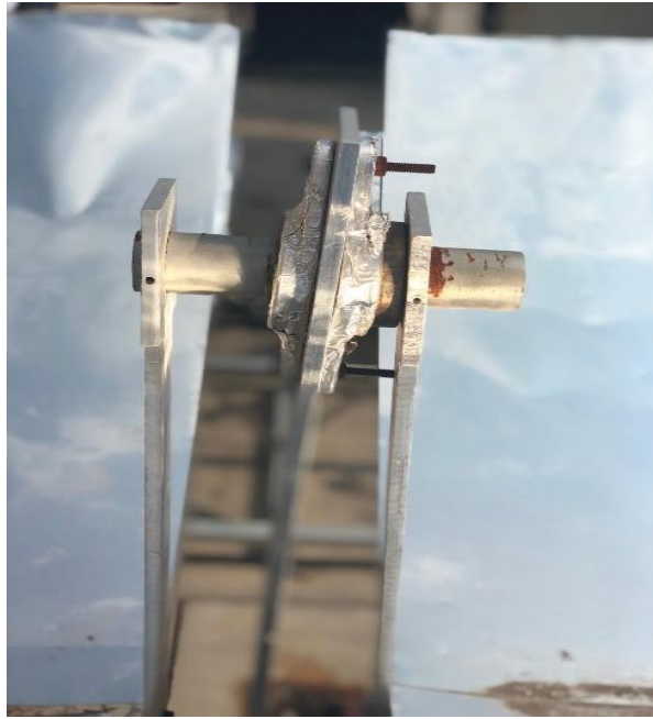
Figura 4.15 foto del sistema de paletas para sujetar y mover el juego de parábolas del sistema.
