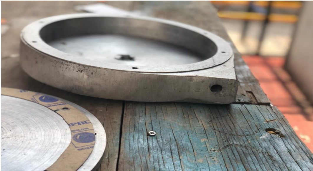
Figura 4.11 Foto del barreno de la carcasa de la turbina para la entrada del vapor.
