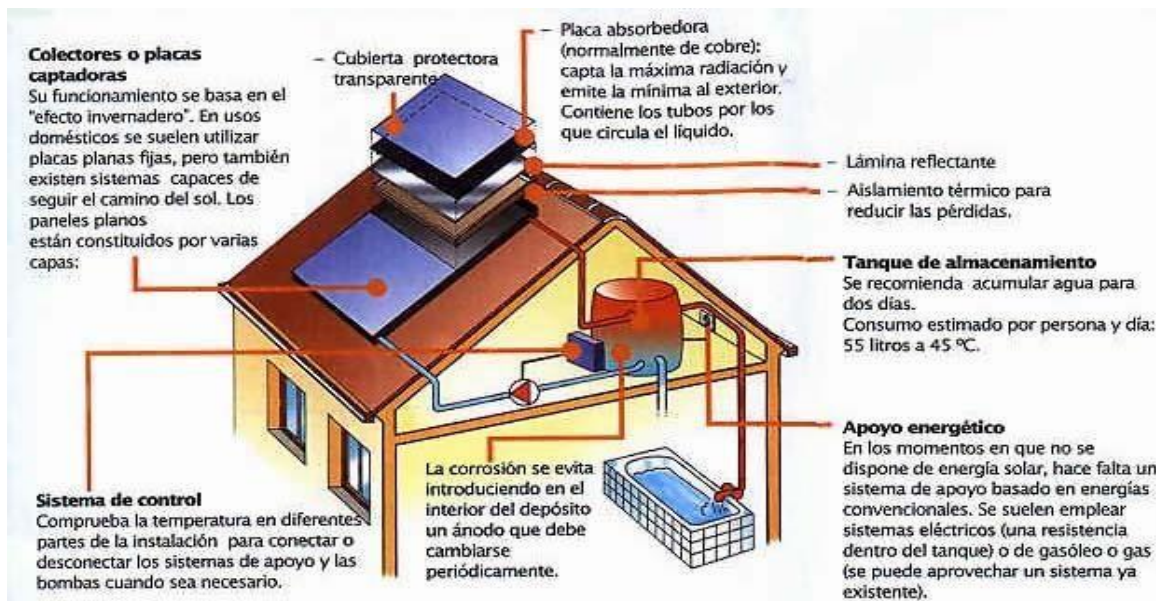
Figura 1.3. diseño de instalación de un sistema de colectores solares de placas.
