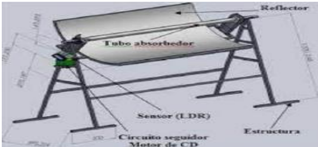
Figura 1.6. Esquema de concentración solar en un tubo al vacío con una parábola concentradora.
