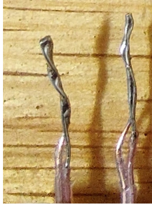
Figura C.1: Manufactura de termopares tipo T
