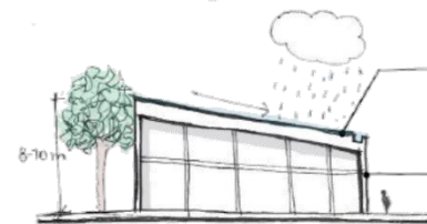
CUBIERTAS INCLINADAS Y SISTEMA DE CAPTACIÓN DE AGUA PLUVIAL EN ESTRUCTURA
