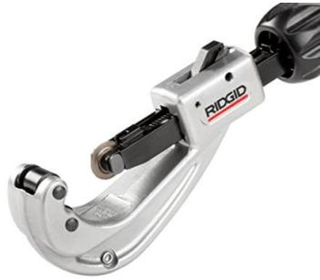
*Figura 5-24. Cortatubo. Como su nombre lo dice sirve para cortar tubos de cobre*
