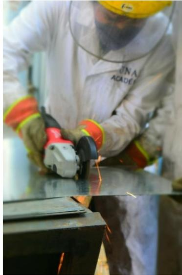
*Figura 5-18. Corte de lámina de acero galvanizado con esmeril.*
