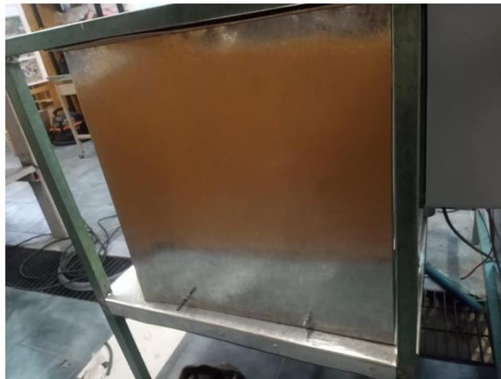
*Figura 5-19. Base de la carcasa remachada y paredes laterales con lámina dobla y atornillada en la parte inferior en perfil angular.*
