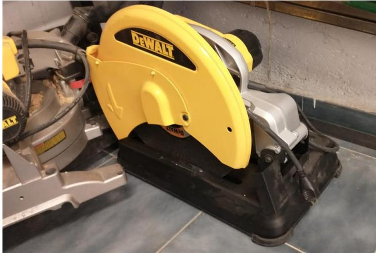
Figura 5-5. Sierra de disco o tronzadora de metal (Diseño y construcción de una bomba de calor geotérmica 3 TR, 2022)
