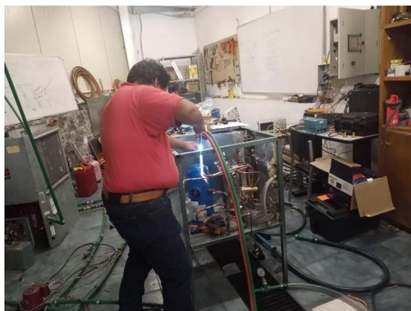
*Figura 5-26. Tubería de cobre soldada con soldadura de plata y oxi-acetileno.*
