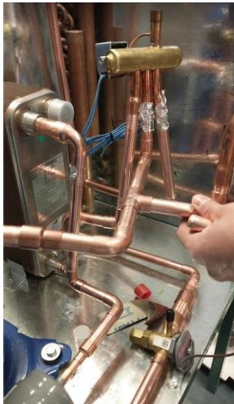
*Figura 5-13. Interconexión y acomodamiento de los tramos de tubería de cobre. (Diseño y construcción de una bomba de calor geotérmica 3 TR, 2022)*
