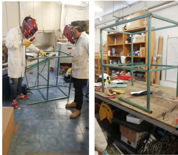
Figura 5-4. PTR en proceso de ser soldado (Diseño y construcción de una bomba de calor geotérmica 3 TR, 2022)
