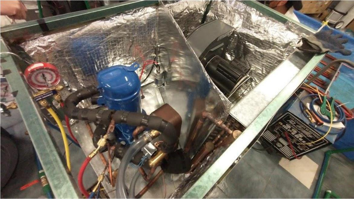
*Figura 5-15. BCG final. (Diseño y construcción de una bomba de calor geotérmica 3 TR, 2022)*
