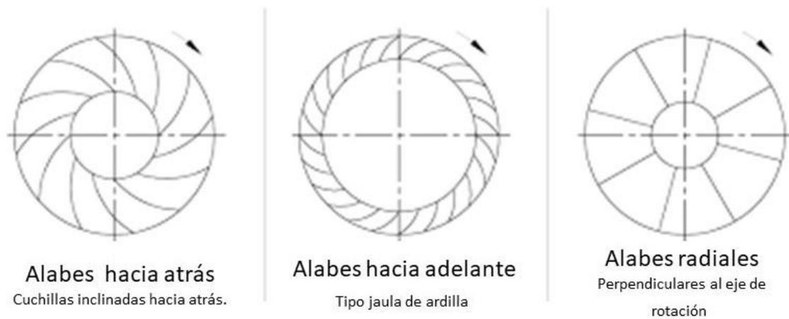
Figura 3-9. Tipos de ventiladores centrífugos
