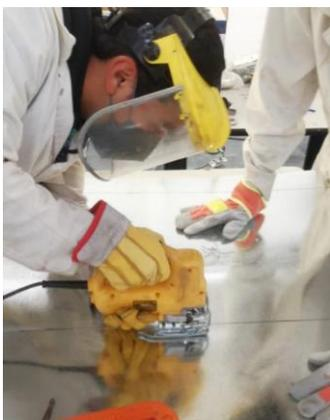
*Figura 5-7. Corte de lámina de acero galvanizado con ayuda de la sierra caladora (Diseño y construcción de una bomba de calor geotérmica 3 TR, 2022)*
