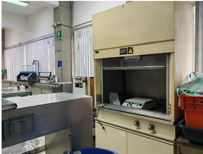
Fotografía 41. Campana de extracción y parrilla de calentamiento utilizadas en la digestión de las muestras.
