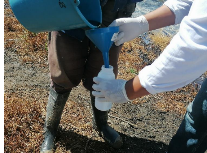
Fotografía 24. Toma de muestra en descarga a laguna de lixiviados (muestra LIX-01-LAG).
