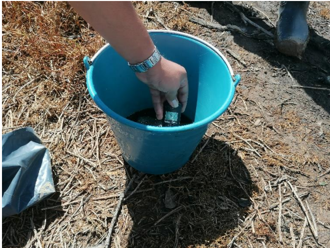
Fotografía 25. Medición de parámetros en campo con medidor portátil marca Hanna (muestra LIX-01-LAG).
