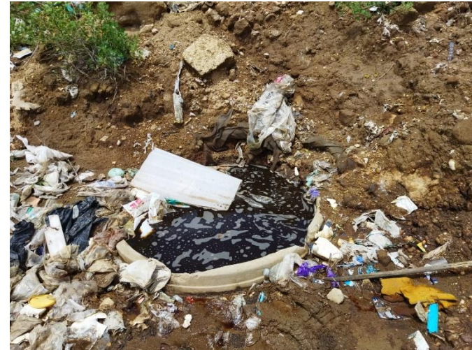
Fotografía 26. Punto de muestreo en cárcamo de lixiviados de celda inactiva, zona sureste.
