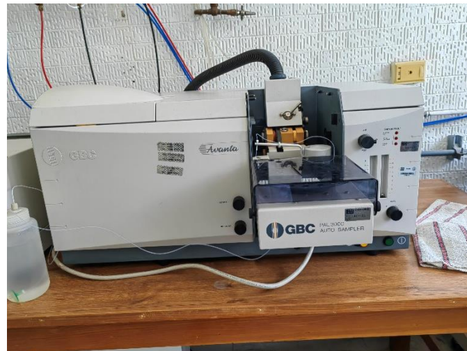
Fotografía 47. Determinaciones analíticas de plomo con Espectrofotómetro de Absorción Atómica por flama.
