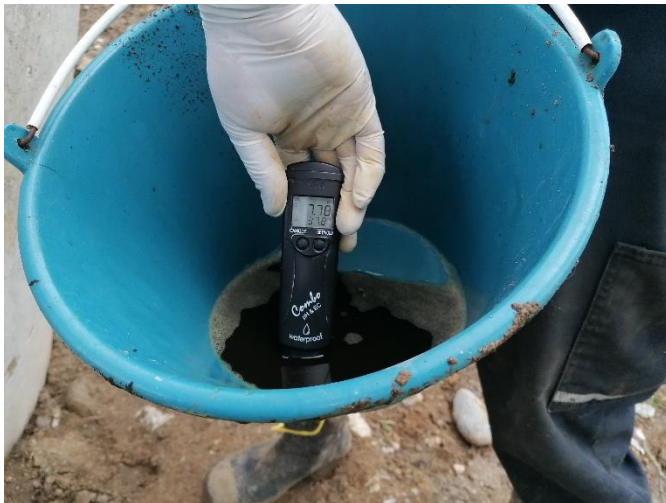
Fotografía 33. Medición de parámetros en campo con medidor portátil marca Hanna (muestra LIX-03-CARC2).
