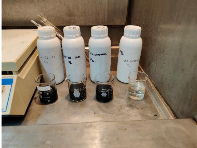
Fotografía 37. Preparación de muestras de lixiviado y agua para digestión.
