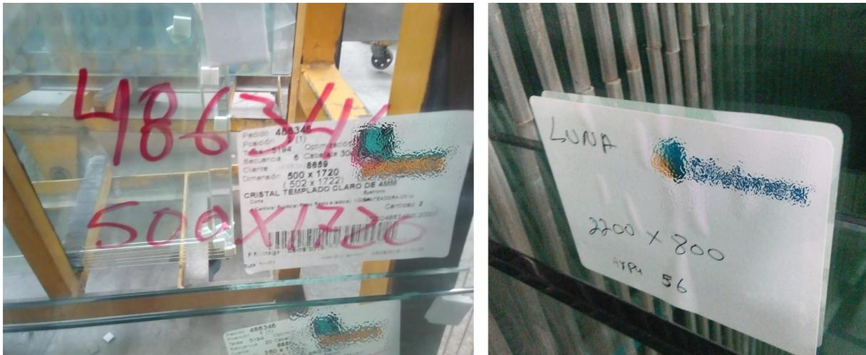
*Nota.* Del lado izquierdo se identifica un vidrio con marcador y del lado derecho se identifica con la etiqueta especial. Imagen propia.
