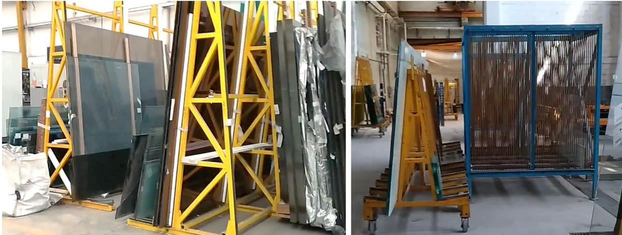
*Nota.* Del lado izquierdo se observan los caballetes donde se apila el material y del lado derecho se observa un arpa que tiene carriles para cada pieza. Imagen propia.
