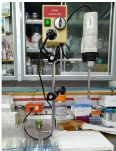
Figura 12: Método de homogenizado de las secciones de hígado y glándula mamaria por la técnica de Folch, con ayuda del Polytron. MA Pérez.
