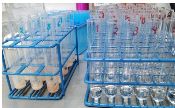
Figura 13: Extracción del contenido lipídico del hígado y GM. Transferencia de la fase orgánica, conteniendo la grasa total, a los tubos de vidrio de 16x100 mm a peso constante. MA Pérez.
