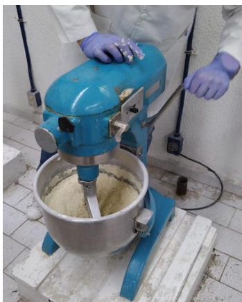
Figura A2: Preparación de la dieta obesogénica con ayuda de un mezclador de paletas (Hobart, modelo A-200, capacidad de 20 L). MA Pérez.
