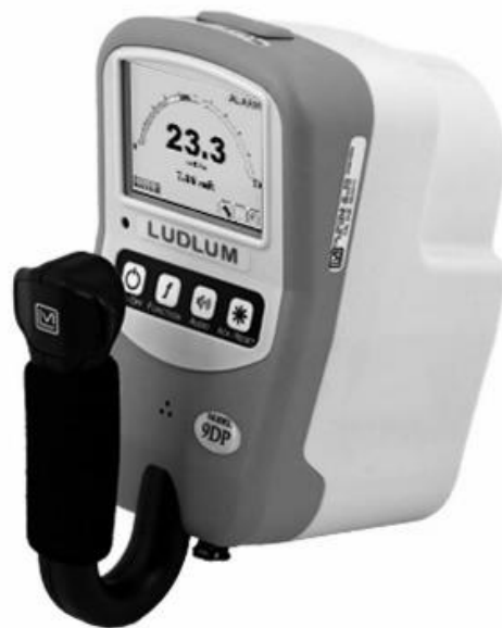
Figura 9. Cámara de Ionización LudLum 9DP-Cole. Colecr. Disponible: http://colec.com/producto/camara-ionizacion-ludlum-modelo-9dp .
