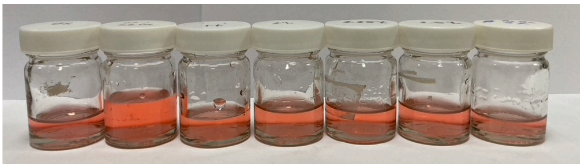
Fig. 25. Muestras de símil líquido de HbO_2 constituido por H_2O_2 + H_2O tridestilada + C_{19}H_{14}O_5S .
