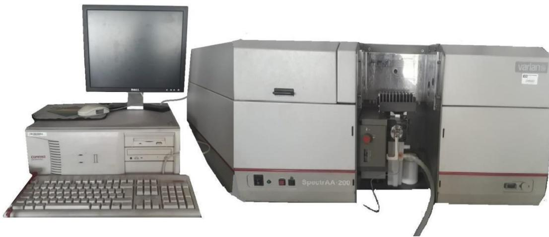
Figura 3.7 Espectrómetro de absorción atómica utilizado en la cuantificación de iones  $\text{Na}^+$  [Elaboración propia].
