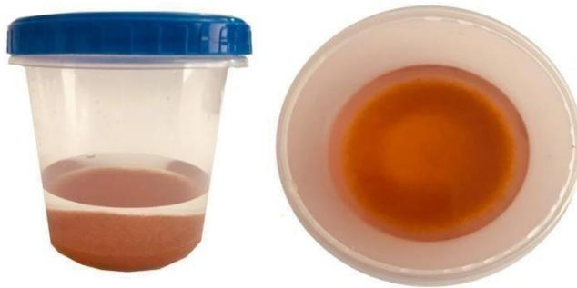
Figura 2.17 Resina de intercambio iónico catiónica-aniónica [Tomada por la autora].
