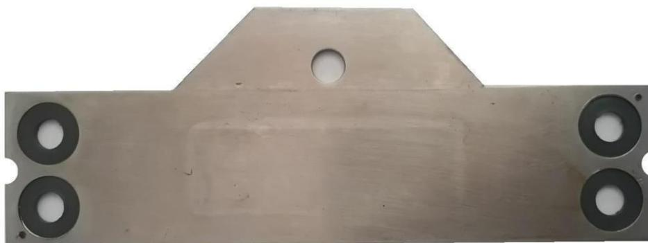
Figura 2.11 Electrodo de titanio platinizado [Tomada por la autora].
