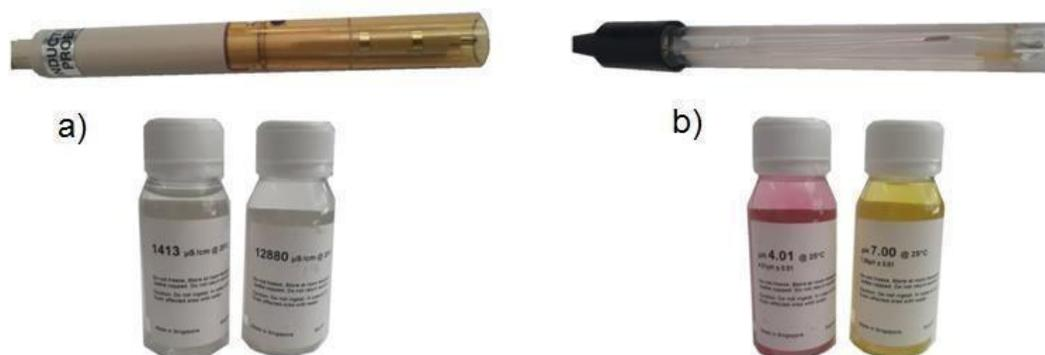
Figura 2.5 Electrodo y sus soluciones para la calibración [Tomada por la autora].
