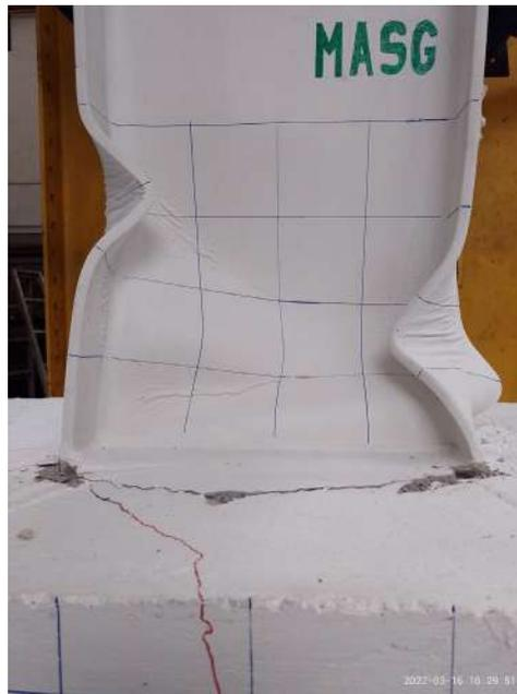
**Figura 5.29 Daños en el espécimen al final de la prueba.**
