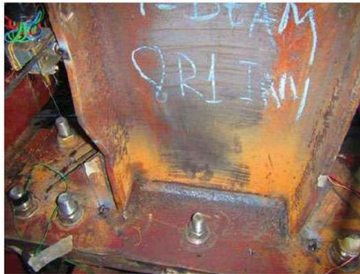
Figura 1.85 Articulación plástica del espécimen T-Beam 8R1 INV (Manos y Nalmpantidou, 2021).
