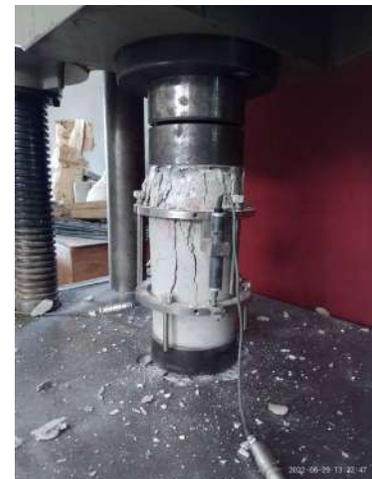
c) Falla en cilindro de concreto.
