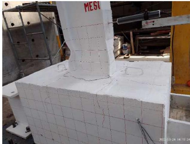
**Figura 5.39 Pandeo global y desprendimiento de concreto.**
