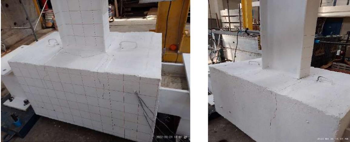
**Figura 4.24 Fisuras en el Espécimen MESC a la altura de los patines de la trabe.**
