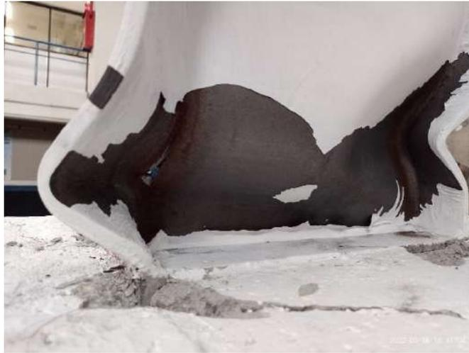
**Figura 4.13** Fractura entre el patín derecho y el alma de la trabe.
