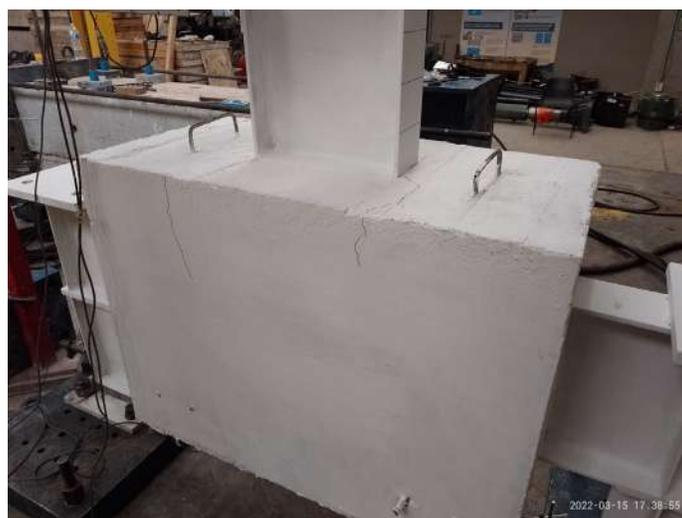
**Figura 5.23 Grietas en la columna en la prueba experimental.**
