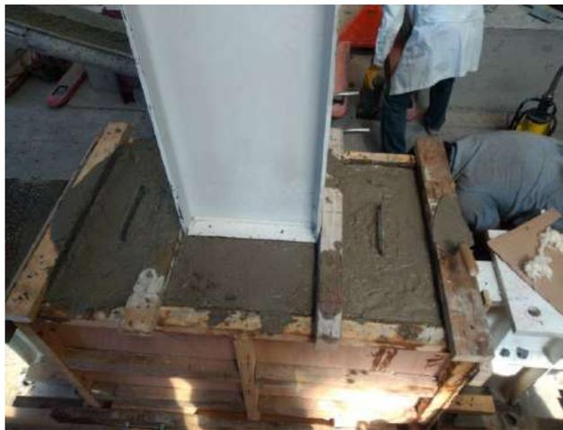
c) Colocación final del concreto en el espécimen.
