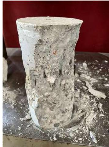
b) Falla en cilindro de concreto.
