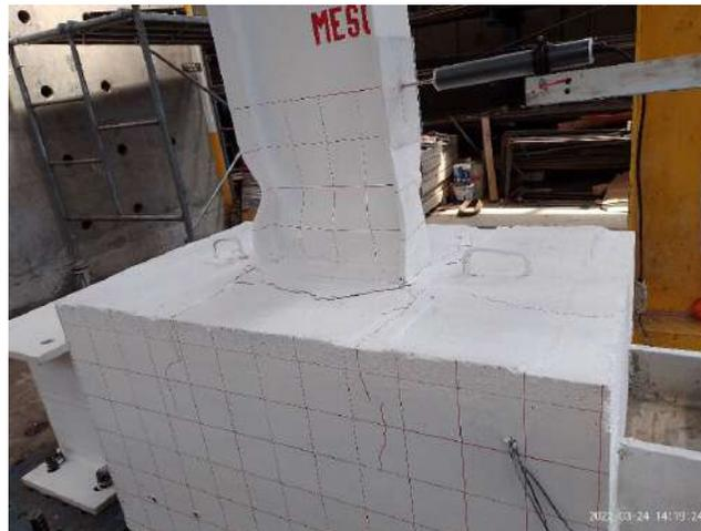
**Figura 5.52 Pandeo global y desprendimiento de concreto.**
