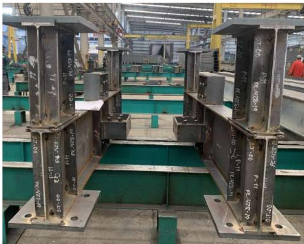
a) Armado de la columna y conexión.
