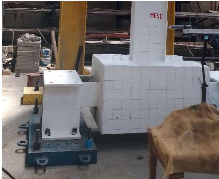
*Figura 3.34 Colocación y anclaje de espécimen MESC a losa de reacción.*
