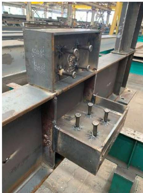
Figura 3.11 Detalle de conexión del espécimen MES1.
