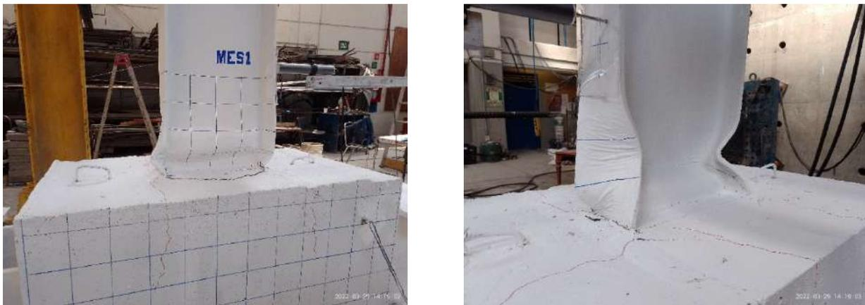
**Figura 4.41 Deformación en patines y alma, formación de articulación plástica.**
