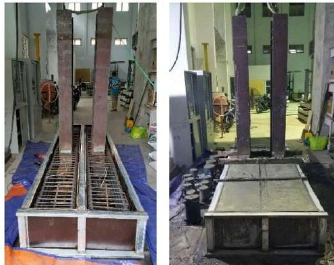
Figura 1.34 Armado y colado de los especímenes (Le et al. 2020).
