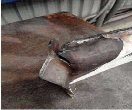
Imagen 4: defecto en muestra 1 visto desde abajo
