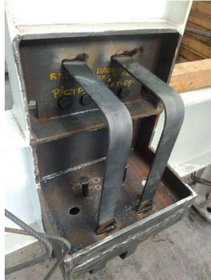
Figura 3.5 Detalle de conexión del espécimen MASG.
