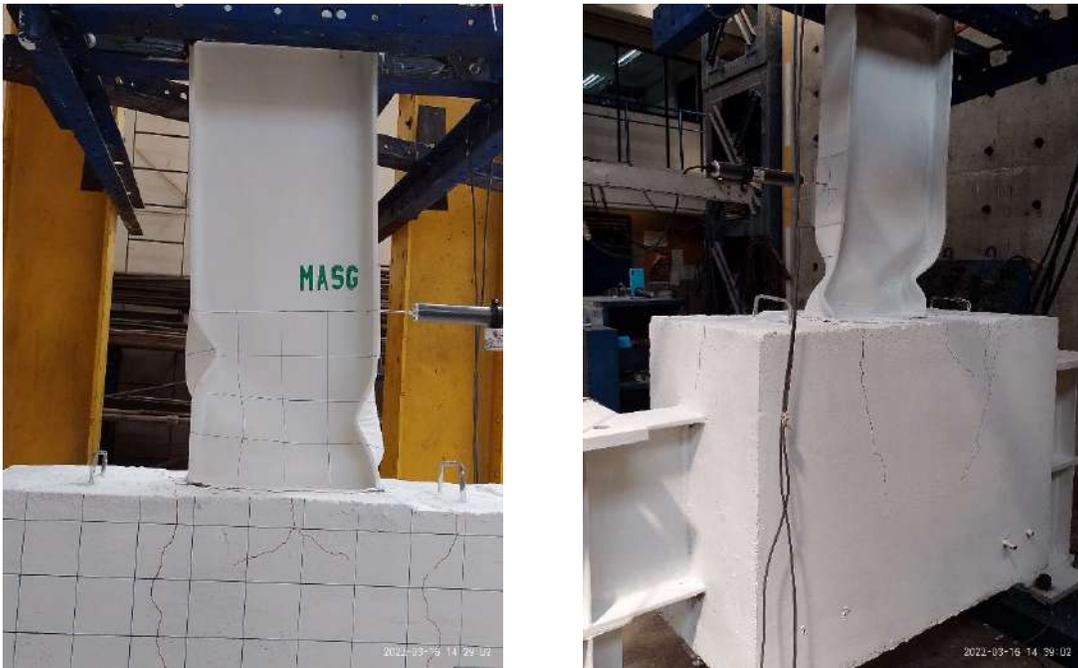
**Figura 4.11** Deformación en patines y alma para una rotación angular de 0.05 rad.
