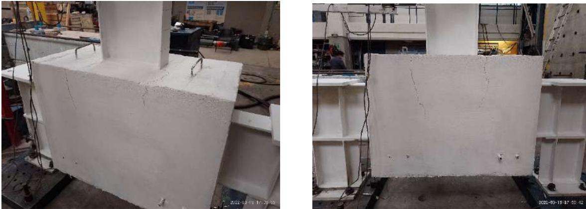
**Figura 4.9 Fisuras por tensión en la columna de concreto.**
