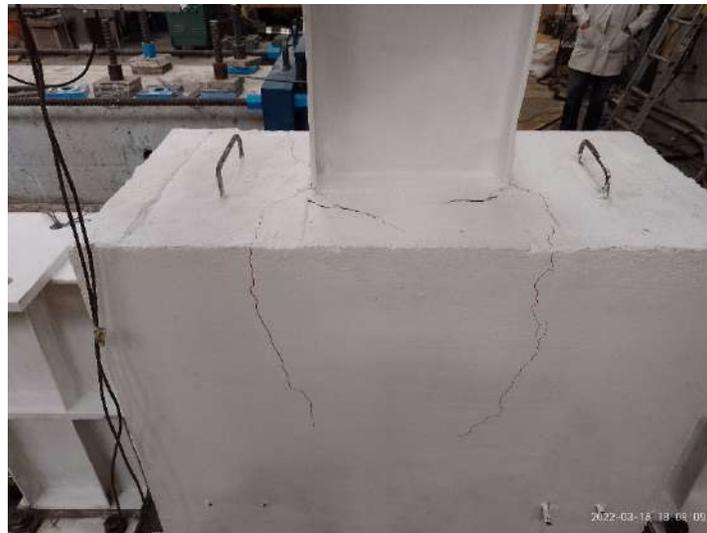
**Figura 4.10 Inicio del pandeo del patín izquierdo y desprendimiento del concreto de la columna.**
