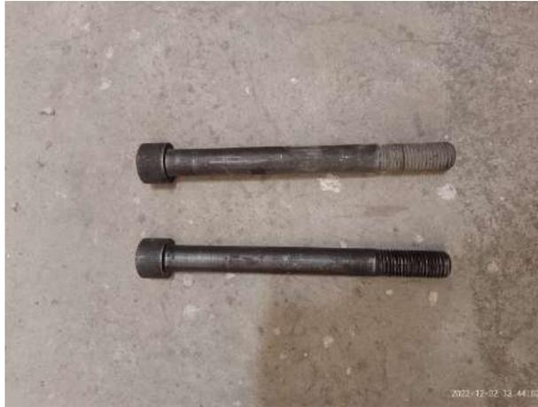
**Figura 3.38 Tornillo utilizado para para la fijación del actuador a la placa PL-C.**
