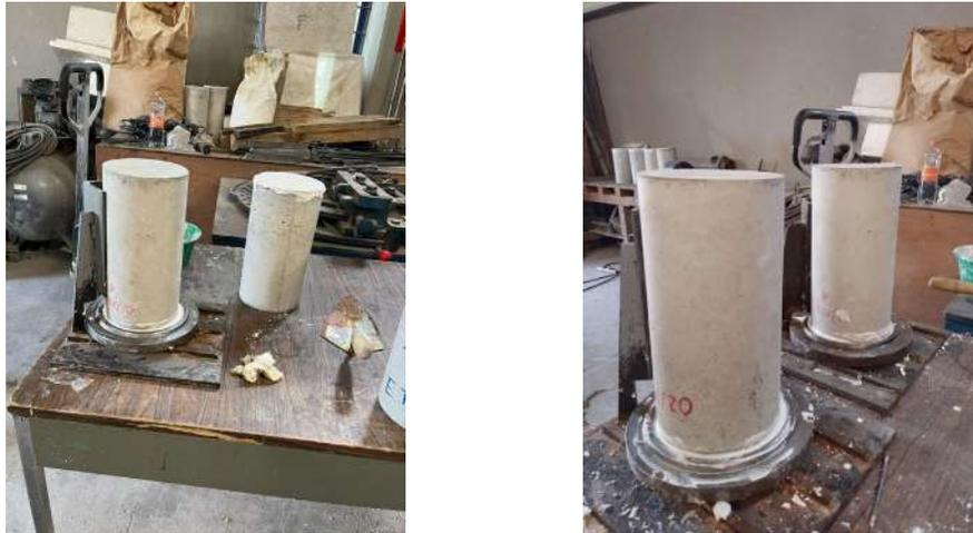
**Figura B.2 Cabeceo de los cilindros con mortero de alta resistencia.**
