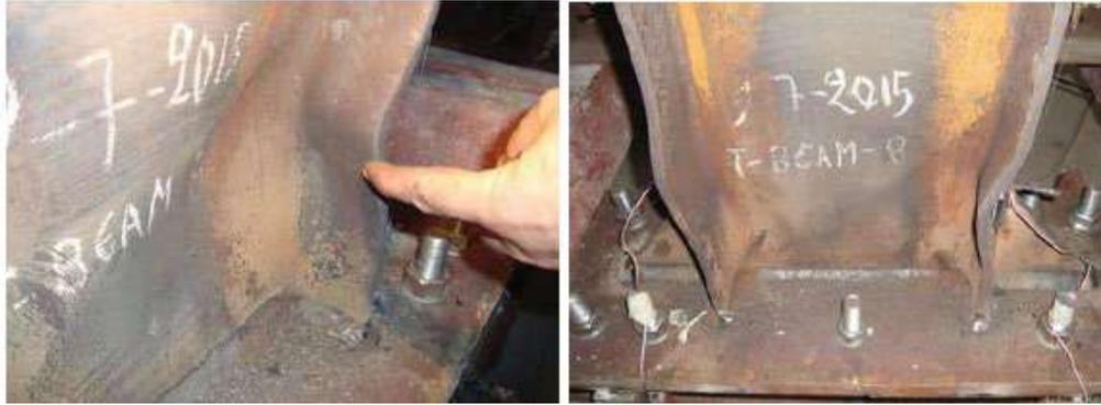
Figura 1.84 Articulación plástica del espécimen T-Beam 8 (Manos y Nalmpantidou, 2021).
