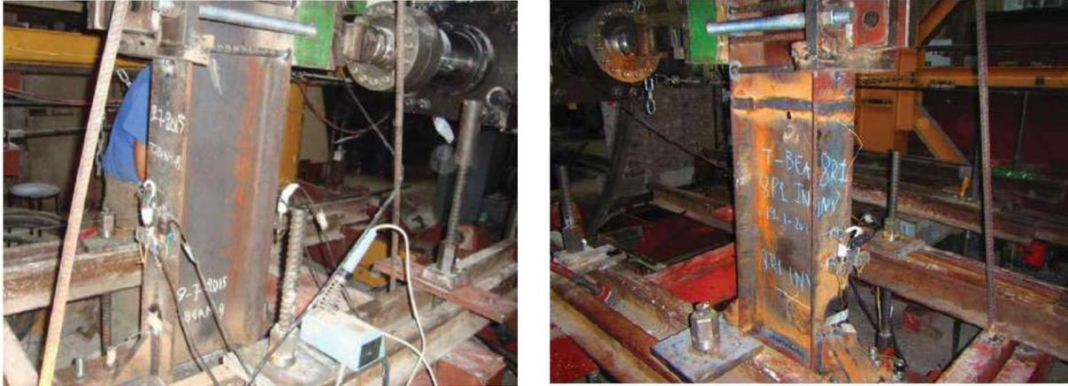
**Figura 1.82** Detalles de la Configuración del espécimen con la unión viga-columna IPE 300 T-Beam 8 e IPE 300 T-Beam 8R1 INV (Manos y Nalmpantidou, 2021).
