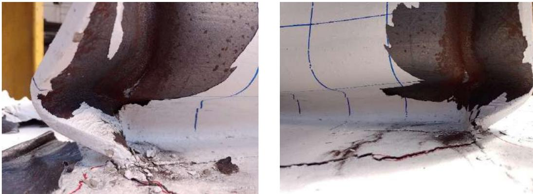
**Figura 4.43** Fractura entre los patines y el alma de la trabe.
