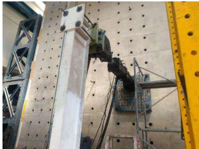
(b) Vista de conexión actuador-especímen.
