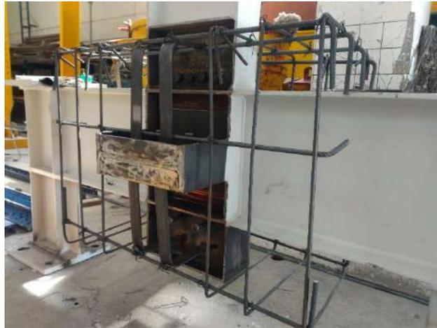
**Figura 3.7 Armado de la conexión MASG.**
