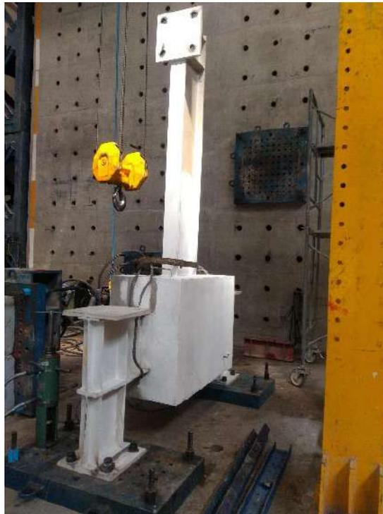
**Figura 3.28 Anclaje del espécimen MASG a la losa de reacción.**
