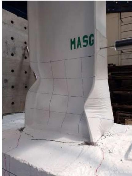
*Figura 5.26 Pandeo global y desprendimiento de concreto.*
