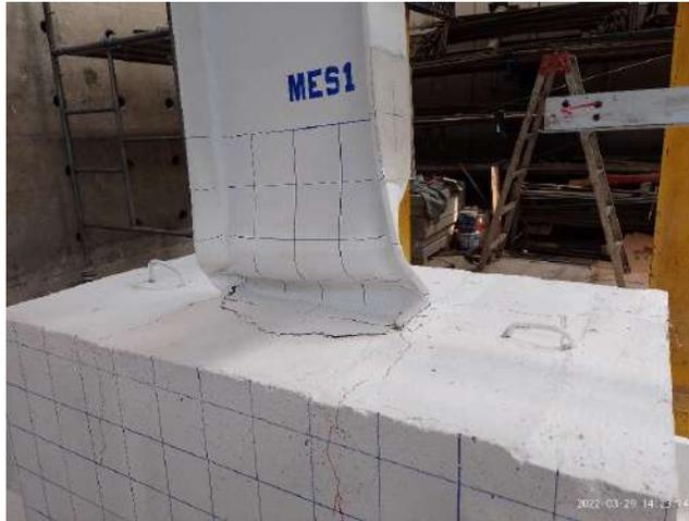
**Figura 5.55 Daños en el espécimen al final de la prueba.**
