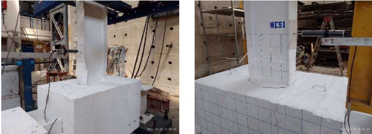
**Figura 4.40 Pandeo de patines y desprendimiento del concreto de la columna.**
