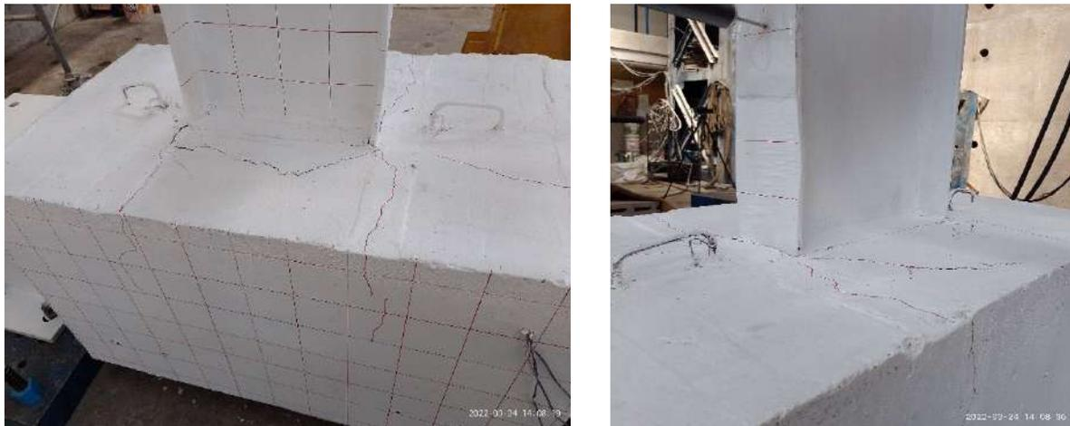
**Figura 4.25 Desprendimiento de concreto y pandeo del patín en el Espécimen MESC.**
