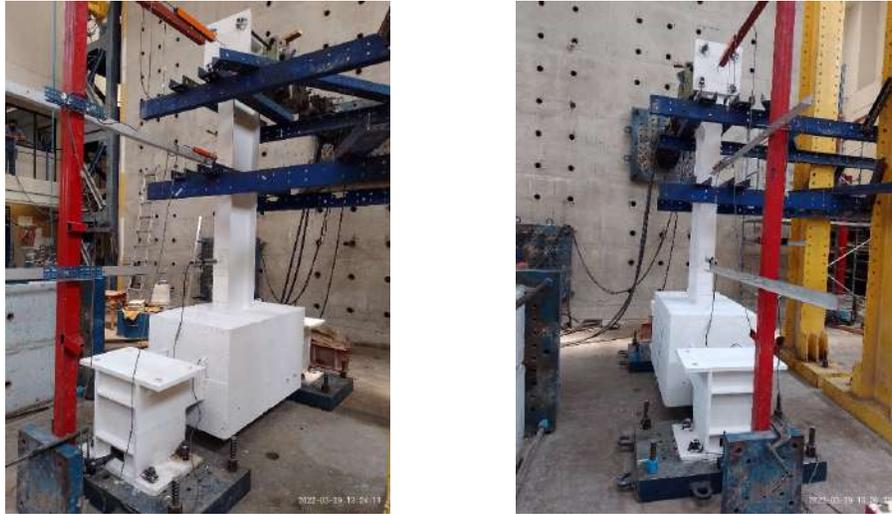
**Figura 4.38** Especimen MES1 con restricciones e instrumentación antes de iniciar la prueba.
