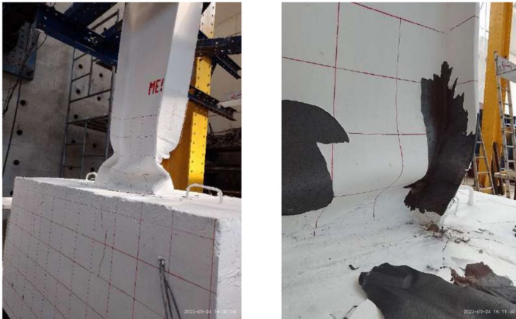
**Figura 4.27 Daños en el espécimen MESC al término de la prueba.**
