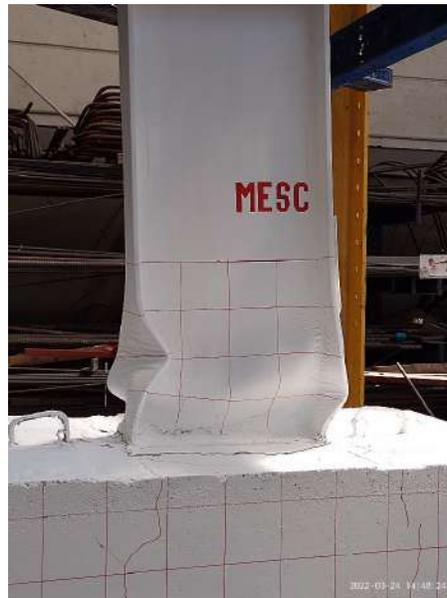
**Figura 5.42** Daños en el espécimen al final de la prueba.
