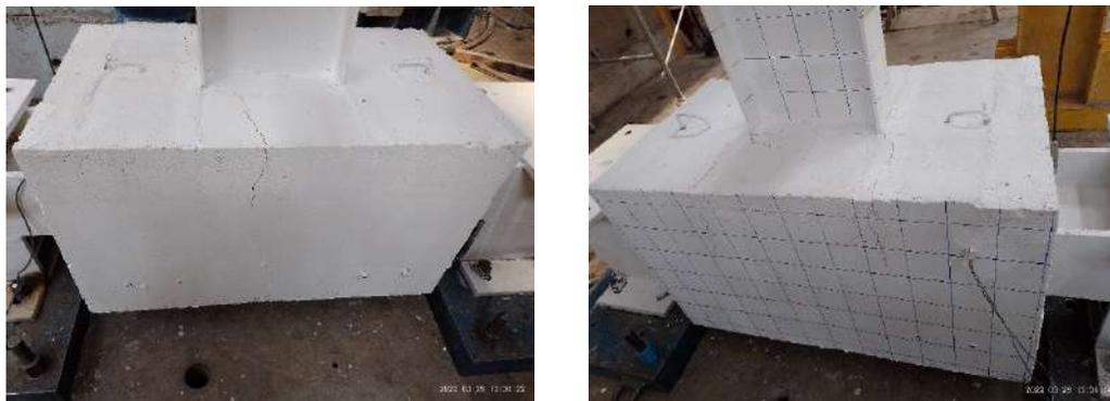
**Figura 4.39** Fisuras por tensión en la columna de concreto.
