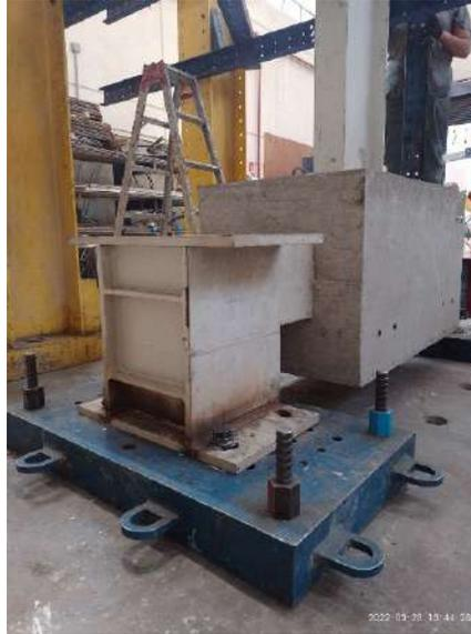
**Figura 3.36 Colocación y anclaje de espécimen MES1 a losa de reacción.**
