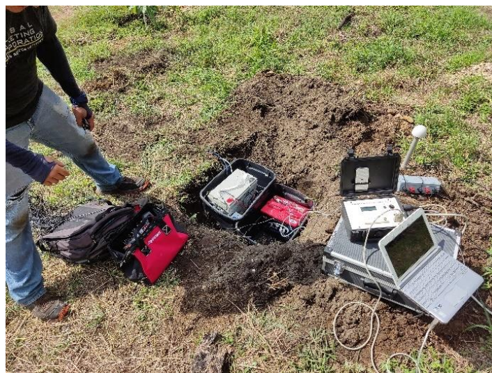
Figura 16. Enterramiento de las estaciones sísmicas locales con el fin de prevenir interrupciones y/o problemas en la adquisición de datos.
