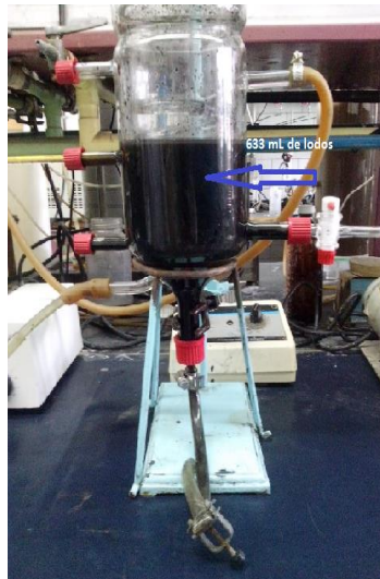
Fig. 3.2. RALLFA a escala de laboratorio instalado (Poblete-Mier, 2015)
