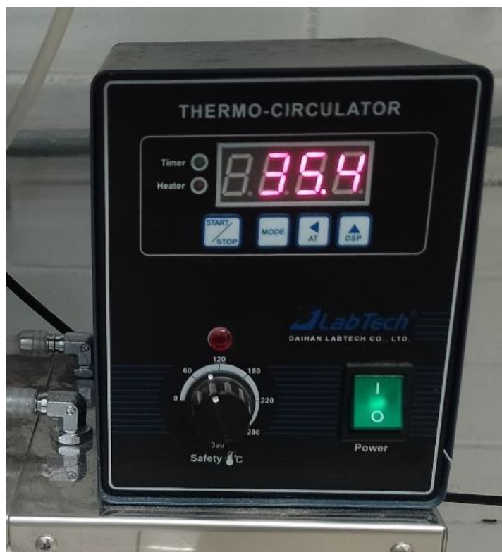
Figura 32. Thermo-circulador LabTech del Laboratorio de Farmacología del Miocardio, FESC. Una vez seleccionada la temperatura deseada del agua circulante, ésta se mantiene constante durante todo el protocolo experimental. Fotografía propia.
