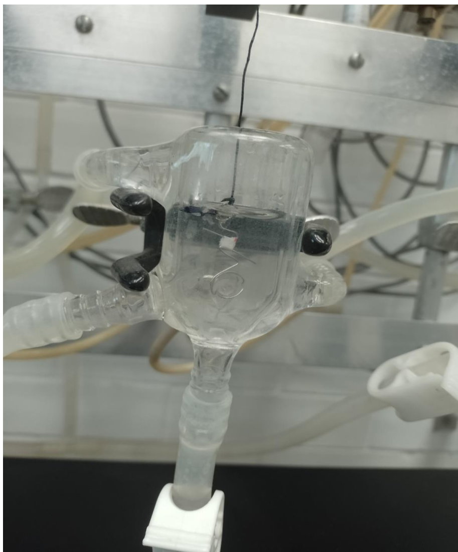
Figura 34. Cámara de órgano aislado con anillo aórtico. El tejido blanquecino (centro) está sujeto verticalmente a dos ganchos de acero, fijándolo a la cámara de órgano (gancho inferior) y al transductor de fuerza mecánica (gancho superior), a la par de que sirven para que el burbujeo de oxígeno no mueva al anillo de aorta. Fotografía propia.
