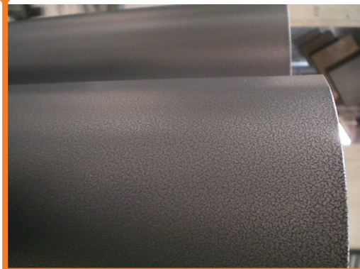
Pintura colocada sobre lámina
