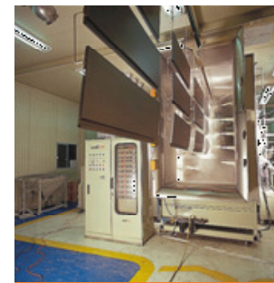
Tren y horno de pintura epóxica.
