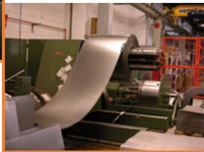
Corte de lámina de acero.
