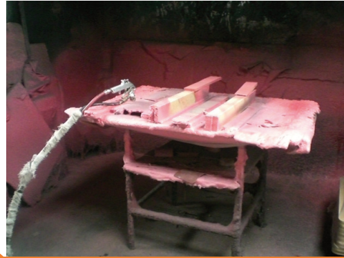
Aplicación de resina a tablero
