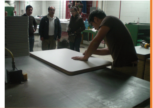
Unión de PVC a tablero
