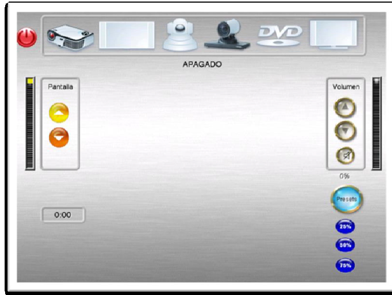
Figura 2.20 Sistema Creston e-control botón PRESETS control de volumen. Elaboración propia (2008).
