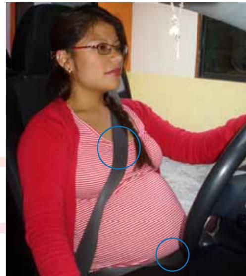
Fig. 24 Ubicación del cinturón de seguridad.
