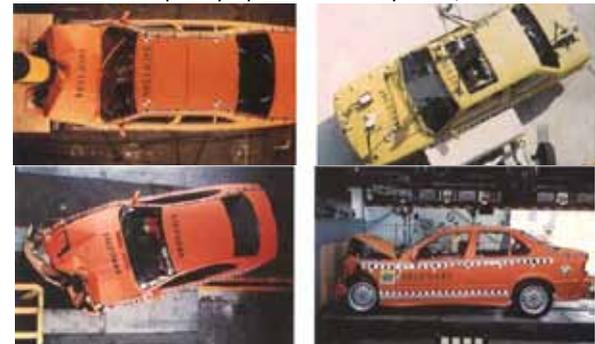
Fig. 17 Pruebas de deformación de automóviles después de un impacto.
