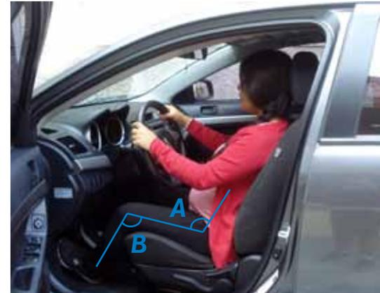
Fig. 21 Postura dinámica de conducción ángulo A ( $110^\circ$  a  $120^\circ$ ) B ( $100^\circ$  a  $115^\circ$ )
