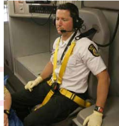
Fig. 28 cinturón de seguridad cinco puntos
