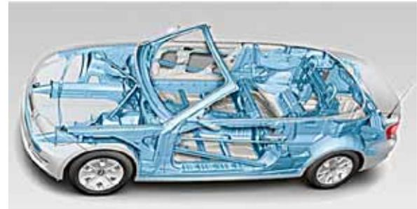
Fig. 16 La carrocería de un automóvil brinda mayor seguridad en el momento de un impacto, ya que está diseñada para deformarse.
