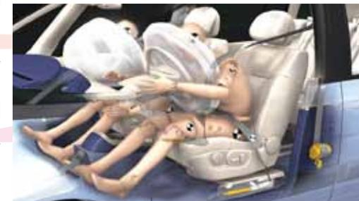
Fig. 22 Ejemplo de como interactúan estos sistemas en el momento del Choque.
