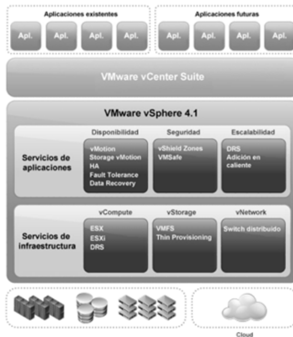
Imagen 2.1. Arquitectura y componentes clave de vSphere del SO del centro de datos virtual (Noticias de Tecnología, 2010).
