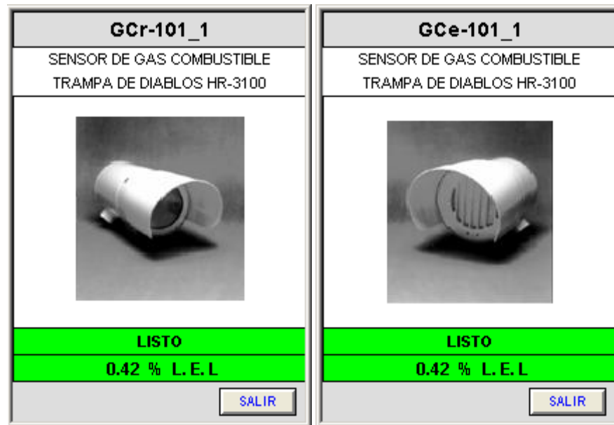
Fig. IV.30 Representación de detectores de gas combustible abierto
