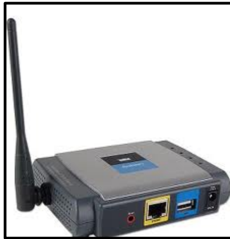
Fig. 1.4 Dispositivo servidor de impresión marca Linksys para conectar impresoras que no cuentan con puertos de comunicación de red.
