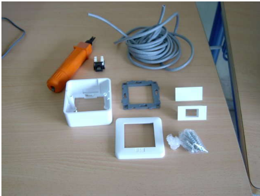
Fig. 3.3.1a Material Cableado de Red
