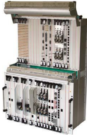
Fig. 3.13 Nodos Ópticos Multi Servicios (OMSN) de la familia 1650 y 1660 SM de Alcatel.
