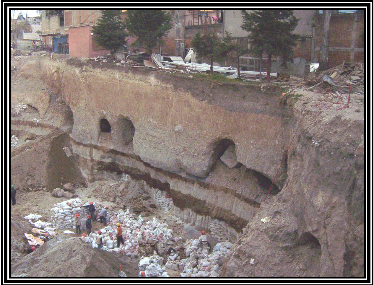
Figura No. 6.- Nótese el tuneleo en distintos niveles, para la extracción de grava y arena, distíngase también, la estratigrafía de los mismos.
